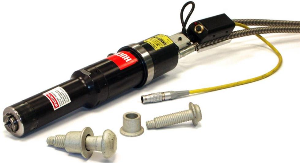
**Beispiele für Schließringbolzen, Schließringe und Setzgerät**
