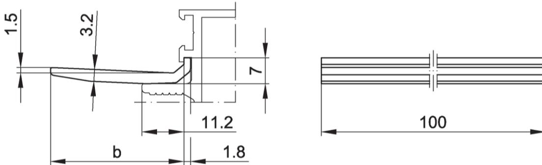
System FWS 50: Glasträger-Standard Ebene 1
