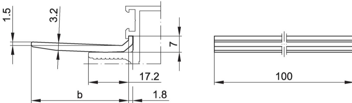
System FWS 50: Glasträger-Standard Ebene 2
