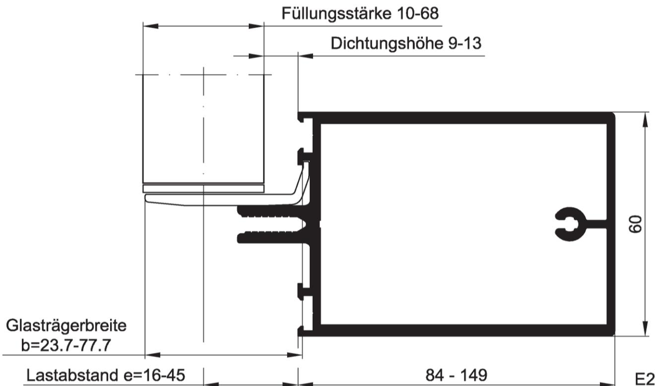
Pfosten-Riegel-Verbindungen (T-Verbindungen) in Kombination mit Glasträgern
