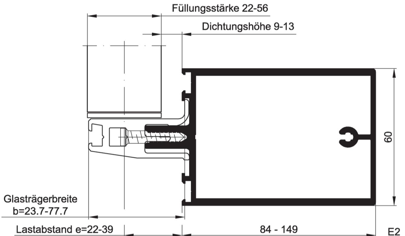
Pfosten-Riegel-Verbindungen (T-Verbindungen) in Kombination mit Glasträgern
