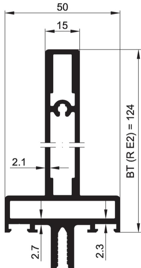
Pfosten-Riegel-Verbindungen (T-Verbindungen) in Kombination mit Glasträgern
