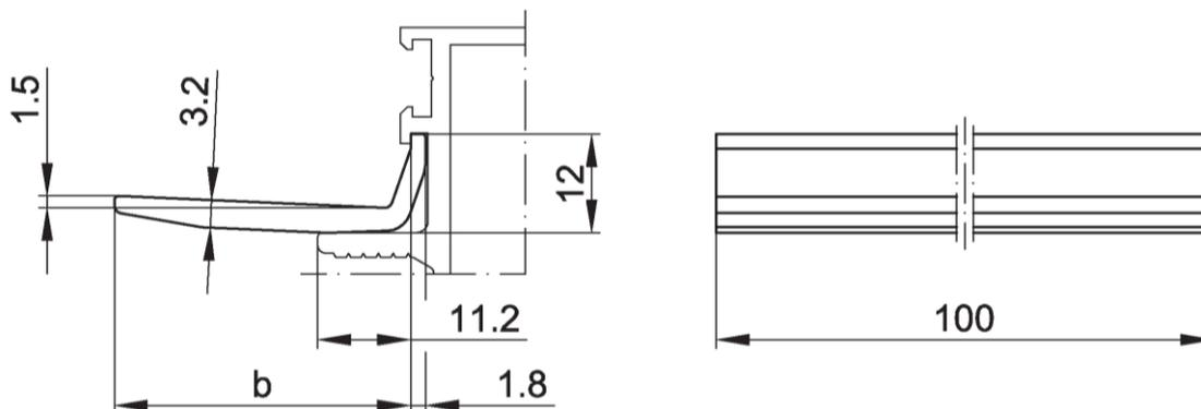
System FWS 60: Glasträger-Standard Ebene 1
