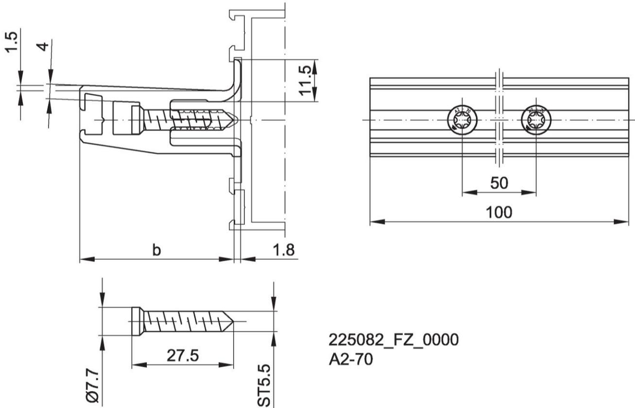
System FWS 60: Glasträger-große Lasten Ebene 2
