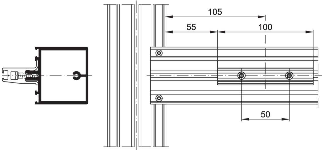
System FWS 60: Position Glasträger-große Lasten Ebene 2
