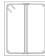
Beispiel 6: Kompaktquerschnitt (Balken bzw. Plattenbalken)
