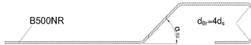
c) Ausführung nichtrostender Betonstahl B500 NR, oberer Querkraftstabschenkels als Schlaufe
