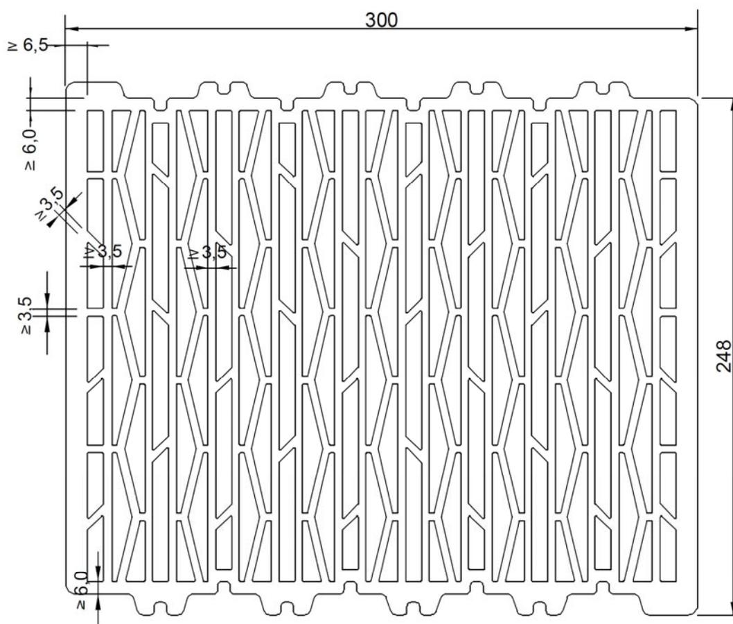
Mauerwerk aus Hochlochziegeln "ThermoBlock T10", "ThermoBlock T11", "ThermoBlock T12" und "ThermoBlock T13" und Leichtmauermörtel LM 21
