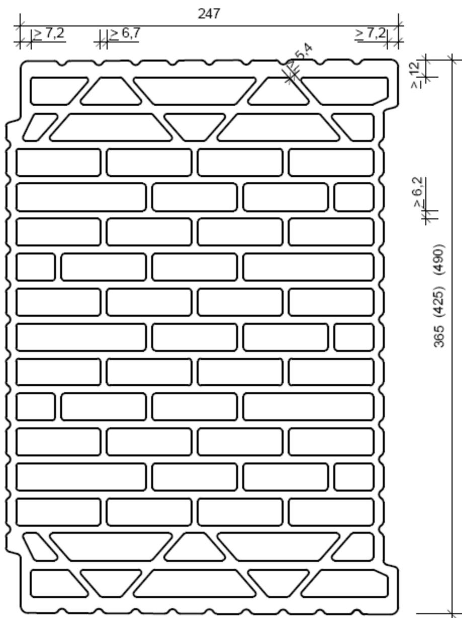
Mauerwerk aus UNIPOR WS07 CORISO Planziegeln
