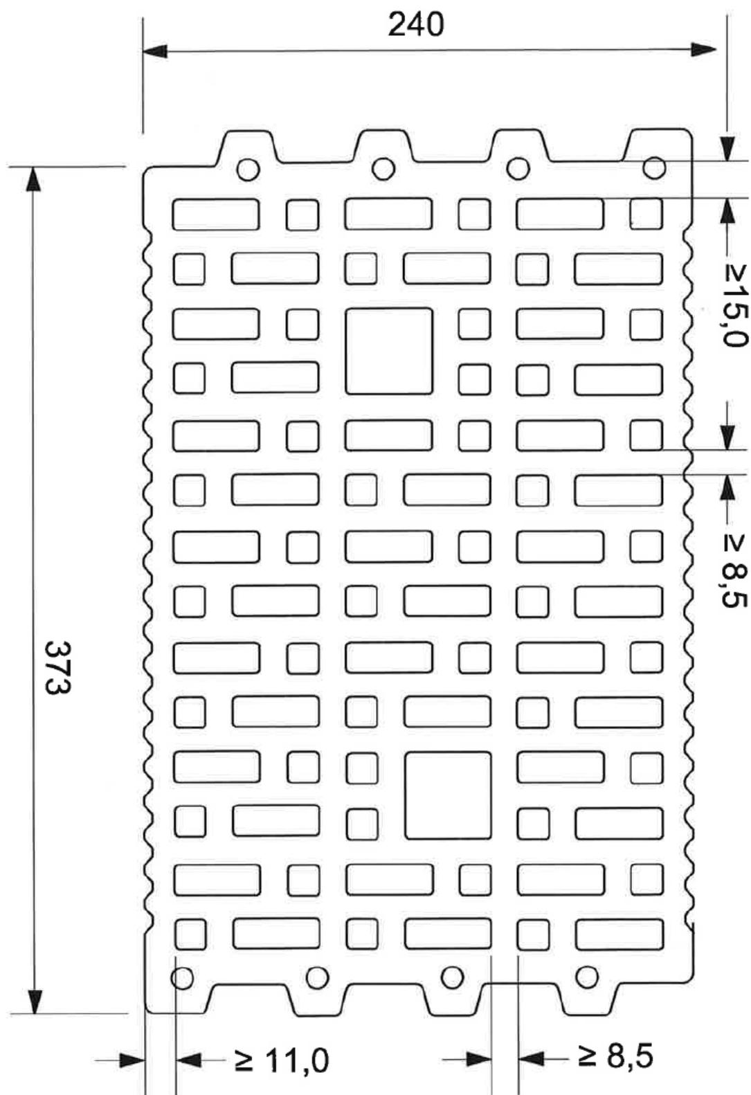
Mauerwerk aus Poroton-Planhochlochziegeln-T der Rohdichteklassen 1,2 und 1,4
