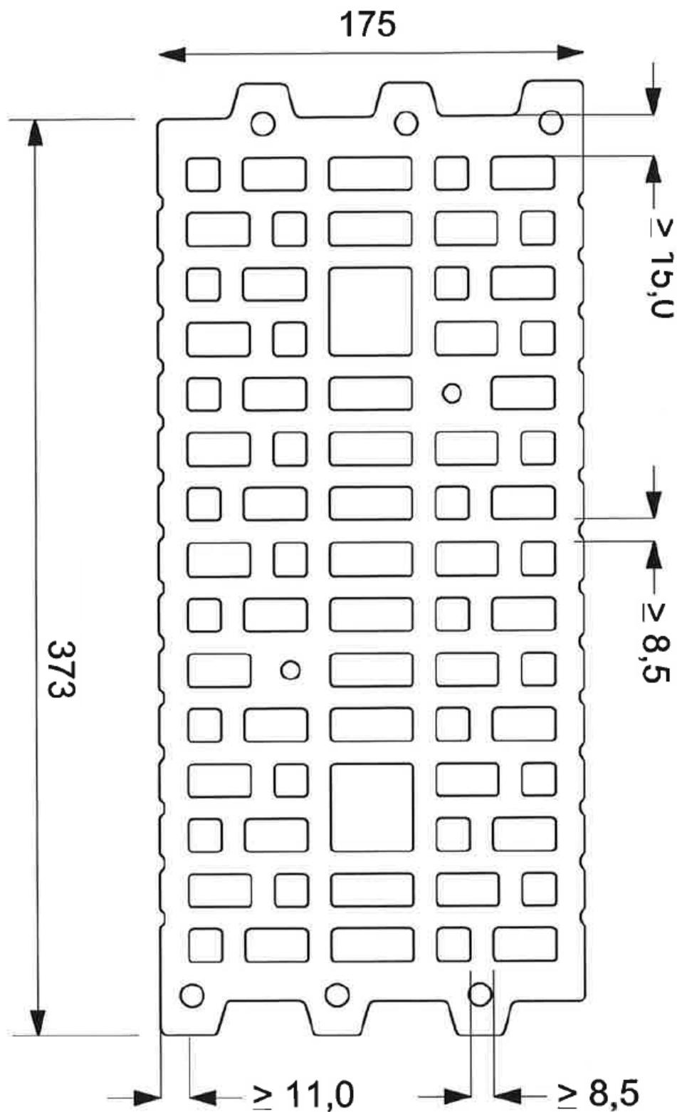
Mauerwerk aus Proton-Planhochlochziegeln-T der Rohdichteklassen 1,2 und 1,4
