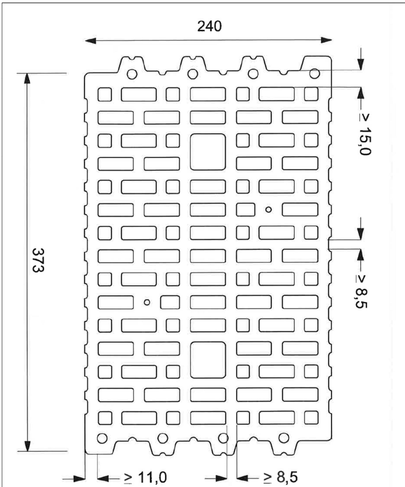
Mauerwerk aus Poroton-Planhochlochziegeln-T der Rohdichteklassen 1,2 und 1,4
