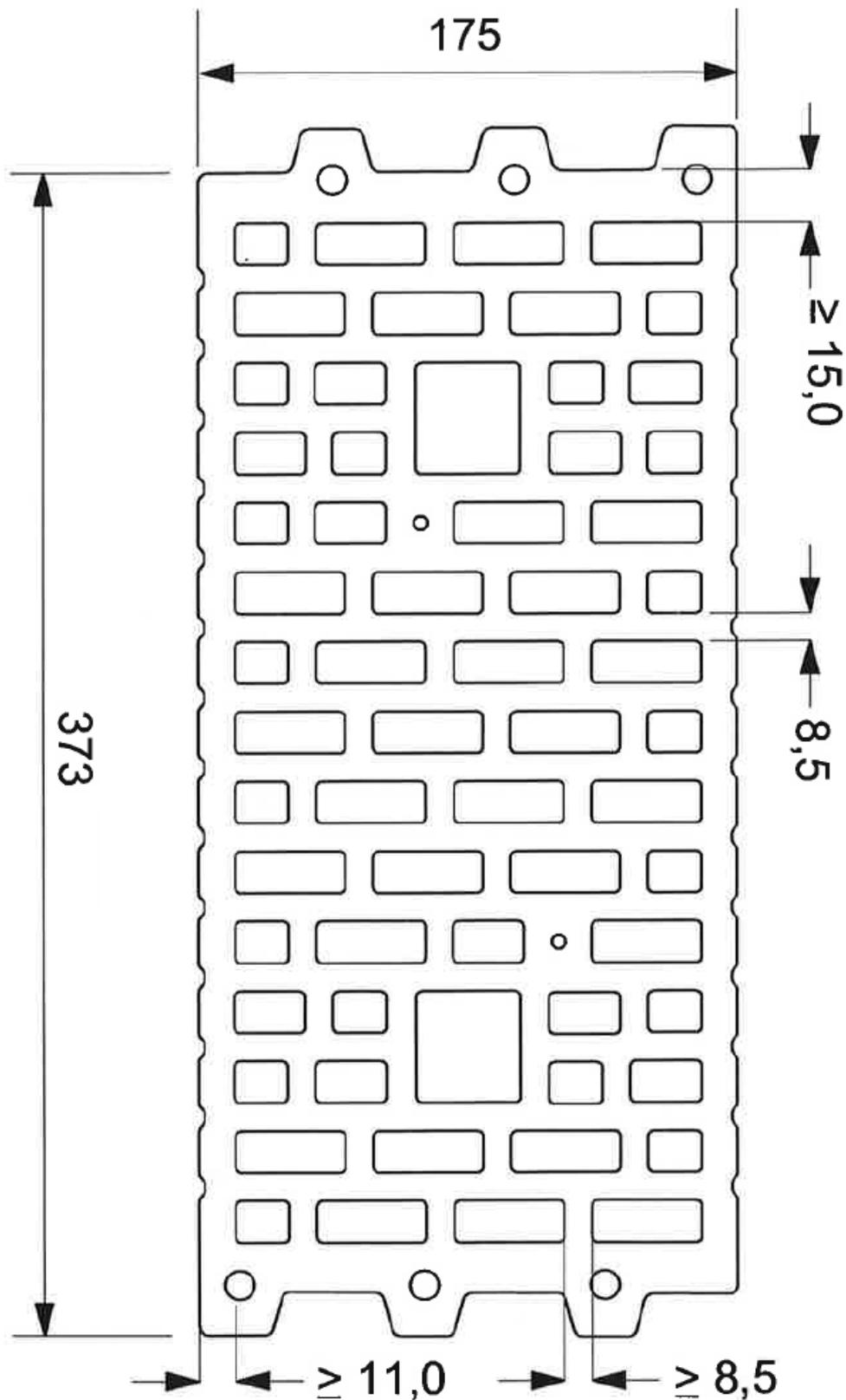
Mauerwerk aus Poroton-Planhochlochziegeln-T der Rohdichteklassen 1,2 und 1,4
