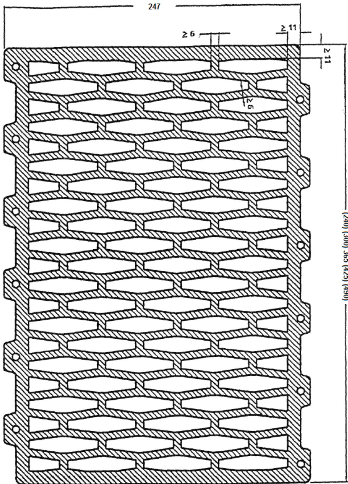
Mauerwerk aus THERMOPOR-Ziegeln "R N+F" mit Rhombuslochung
