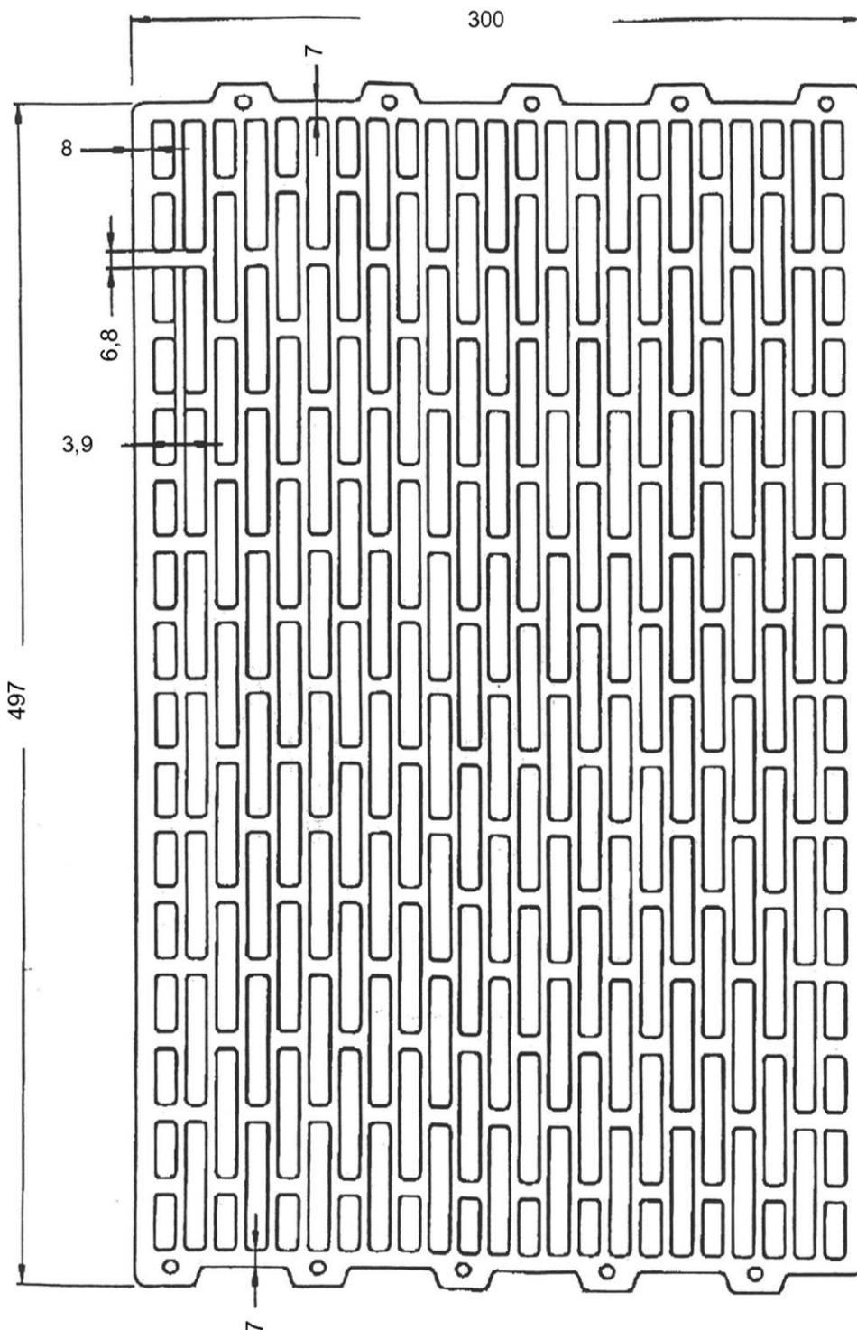
Mauerwerk aus ZMK-Planziegeln WZ 11 und WZ 12
