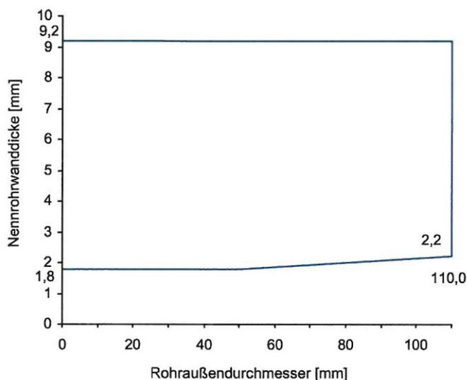
Rohre der Rohrgruppe B nach Anlage 1: PE-HD, PE-LD, PP, ABS, ASA, PE-X, PB, PS
