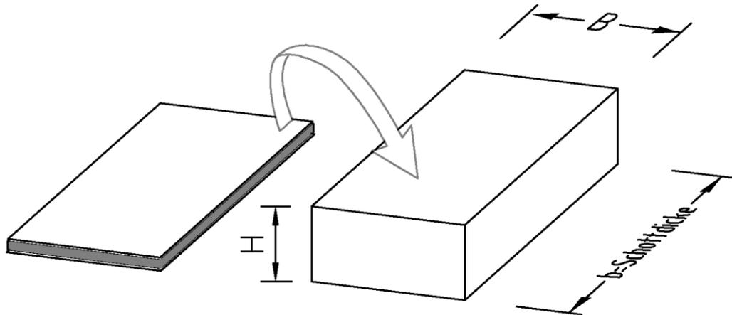
Der ZZ-Vakuumstein 200 BDS-N wird in Restspalte eingefügt und verschließt diese nach Öffnen der Folie. Wahlweise darf der ZZ-Vakuumstein 200 BDS-N mit oder ohne Folie eingebaut werden.
