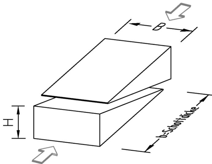
Der Nachinstallationskeil vereinfacht in schwierigen Einbaulagen das nachträgliche Öffnen der Kabelabschottung. Die mit den Nachinstallationskeilen belegte Schottfläche darf eine Größe 30 cm x 15 cm (B x H) nicht überschreiten.
