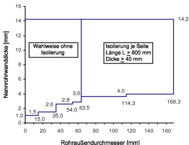
**Rohre aus Kupfer nach Anlage 1 mit Isolierungen aus Mineralfaser-
