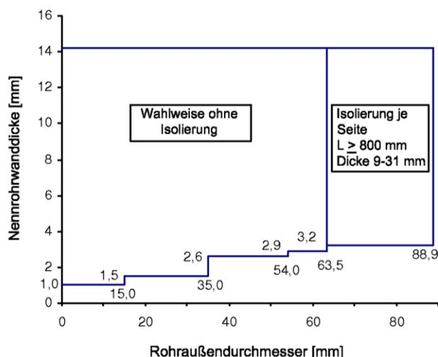
**Rohre aus Kupfer nach Anlage 1 mit Isolierungen aus synthetischem Kautschuk gemäß Abschnitt 2.1.4.2:**
