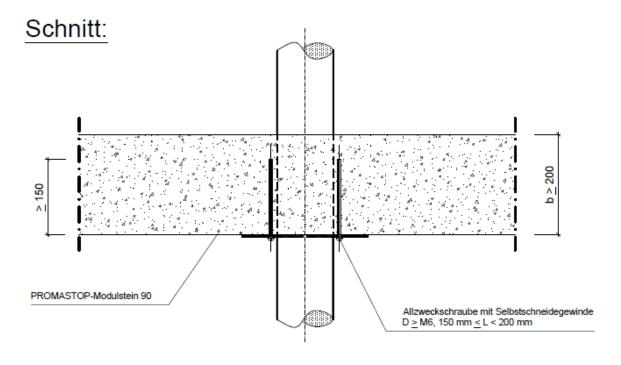
Kabelabschottung (Kombiabschottung) "PROMASTOP-Kombischott, Modulstein" der Feuerwiderstandsklasse S 90 nach DIN 4102-9
