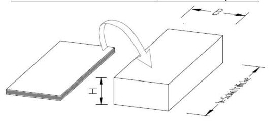
Der Vakuumstein wird in die Restspalte eingefügt und verschließt diese nach Öffnen der Folie. Wahlweise darf der Vakuumstein mit oder ohne Folie eingebaut werden.
