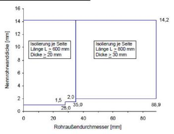
Für die Rohrisolierung müssen nichtbrennbare (Baustoffklasse DIN 4102-A) Mineralfasermatten oder Mineralfaserschalen verwendet werden, deren Schmelzpunkt über 1000 °C nach DIN 4102-17 liegen muss. Die Nennrohdichte muss mindestens 90 kg/m³ betragen.
