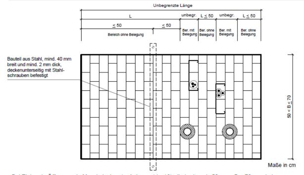
Bei Einbau in Öffnungen in Massivdecken (s. Anlagen 14 - 16), die breiter als 50 cm < B  $\leq$  70 cm sind, muss in Abschottungen ohne Belegung bzw. in Bereichen ohne Belegung mit einer Länge L > 50 cm eine der folgenden Maßnahmen erfolgen (s.a. Abschnitt 4.4.7):
