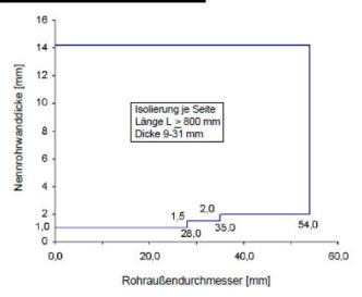
Für die Rohrisolierung muss synthetischer Kautschuk (Baustoffklasse DIN 4102-B1) gem. Abschnitt 2.1.4.2 verwendet werden. Die Rohrisolierung und der Mantel dürfen wahlweise durch die Abschottung hindurchgeführt werden oder an der Schottoberfläche angrenzen.
