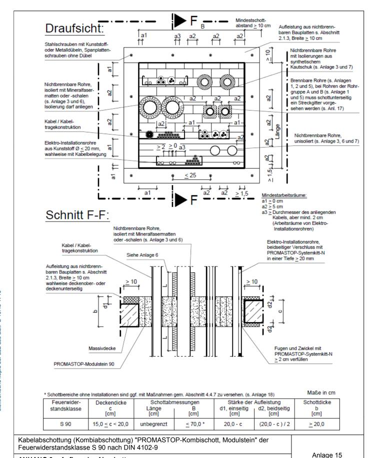
Aufbau der Kombiabschottung bei Einbau in Decken mit einer Dicke  $\epsilon$  15 cm und
