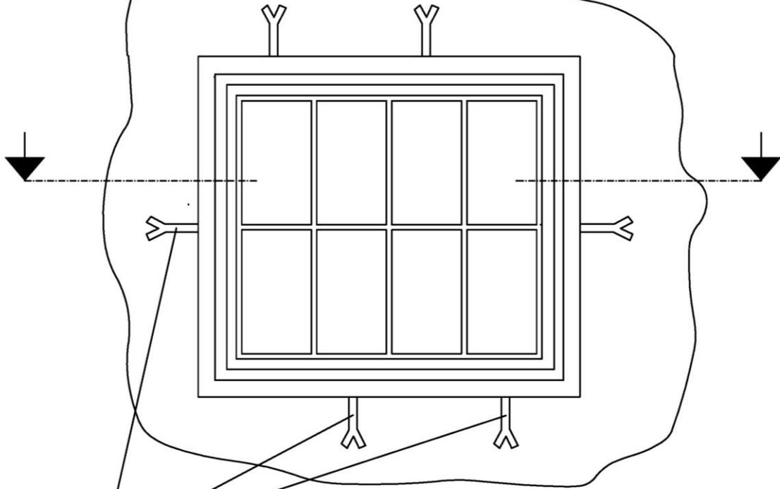
Maueranker 30 x 4 x 150 (an den Längsseiten 1 Anker für je 2 Rahmen, an den Schmalseiten je 1 Anker)
