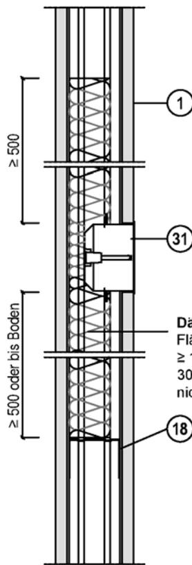
**Dämmstoff, Schmelzpunkt  $\geq 1000\text{ °C}$**
