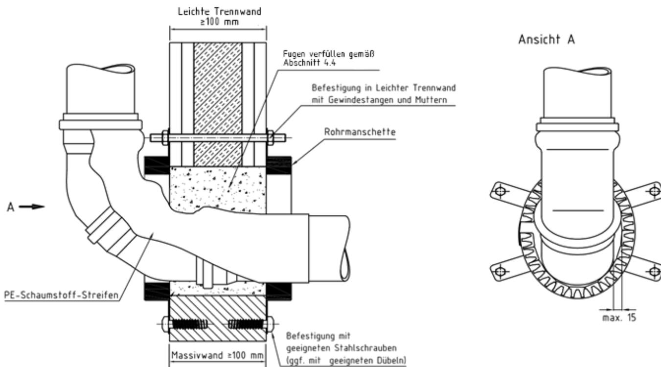
Rohrabschottung "Curaflam System XS<sup>Pro</sup>" bzw. "System FS-M R1"
