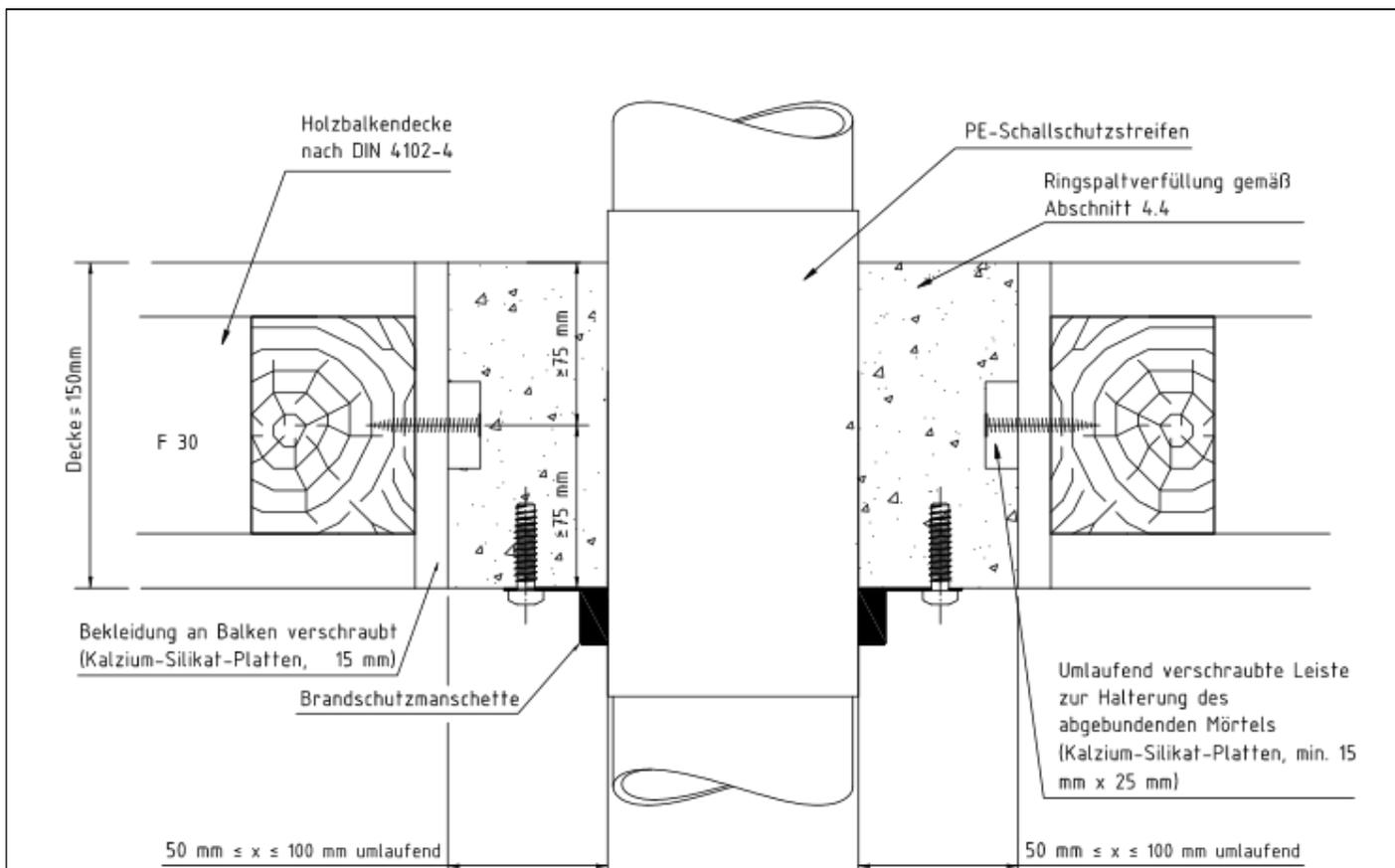
Rohrabschottung "Curafam System XS<sup>Pro</sup>" bzw. "System FS-M R1" der Feuerwiderstandsklasse R 90 nach DIN 4102-11
