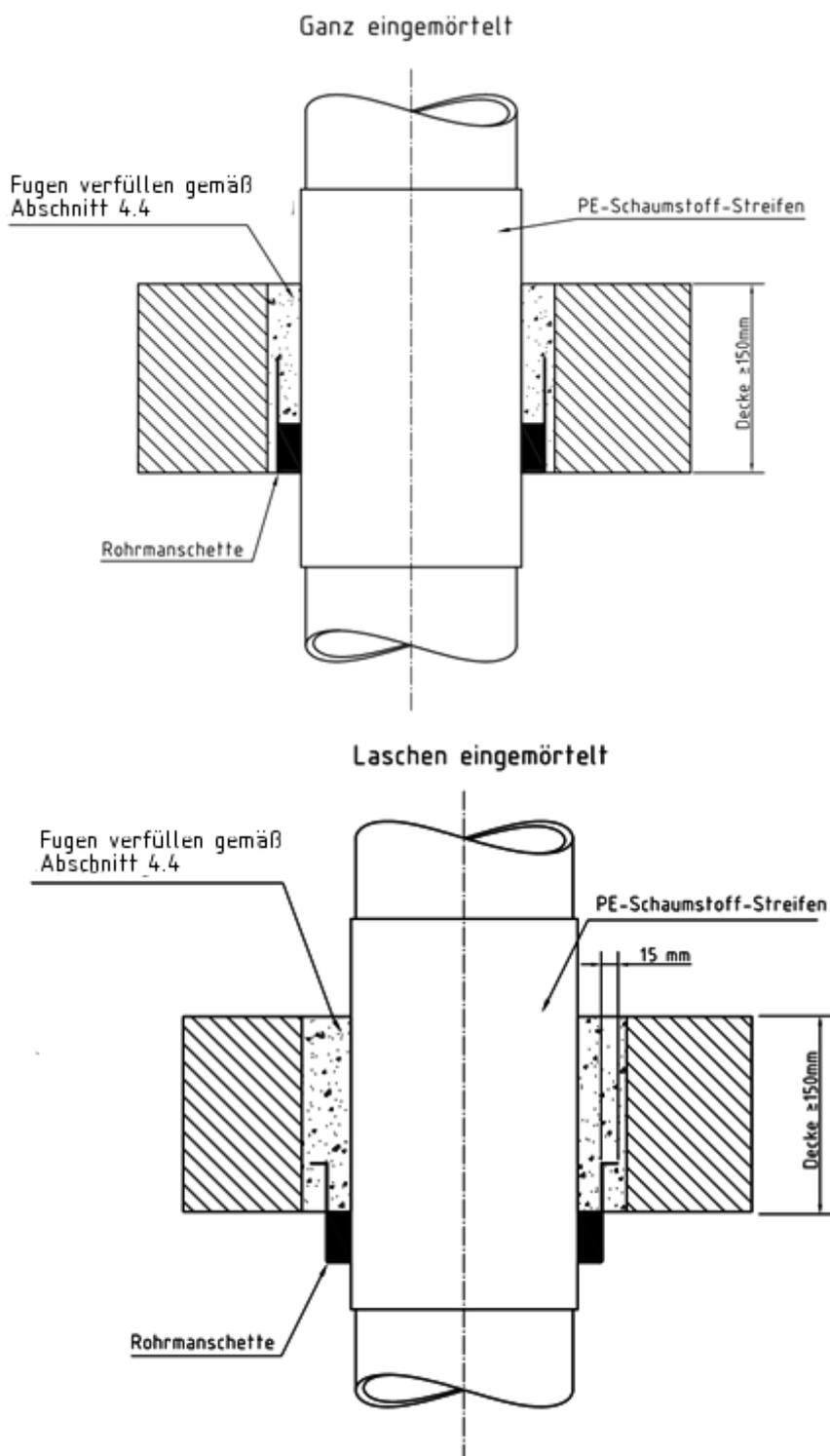
Rohrabschottung "Curaflam System XS<sup>Pro</sup>" bzw. "System FS-M R1"
