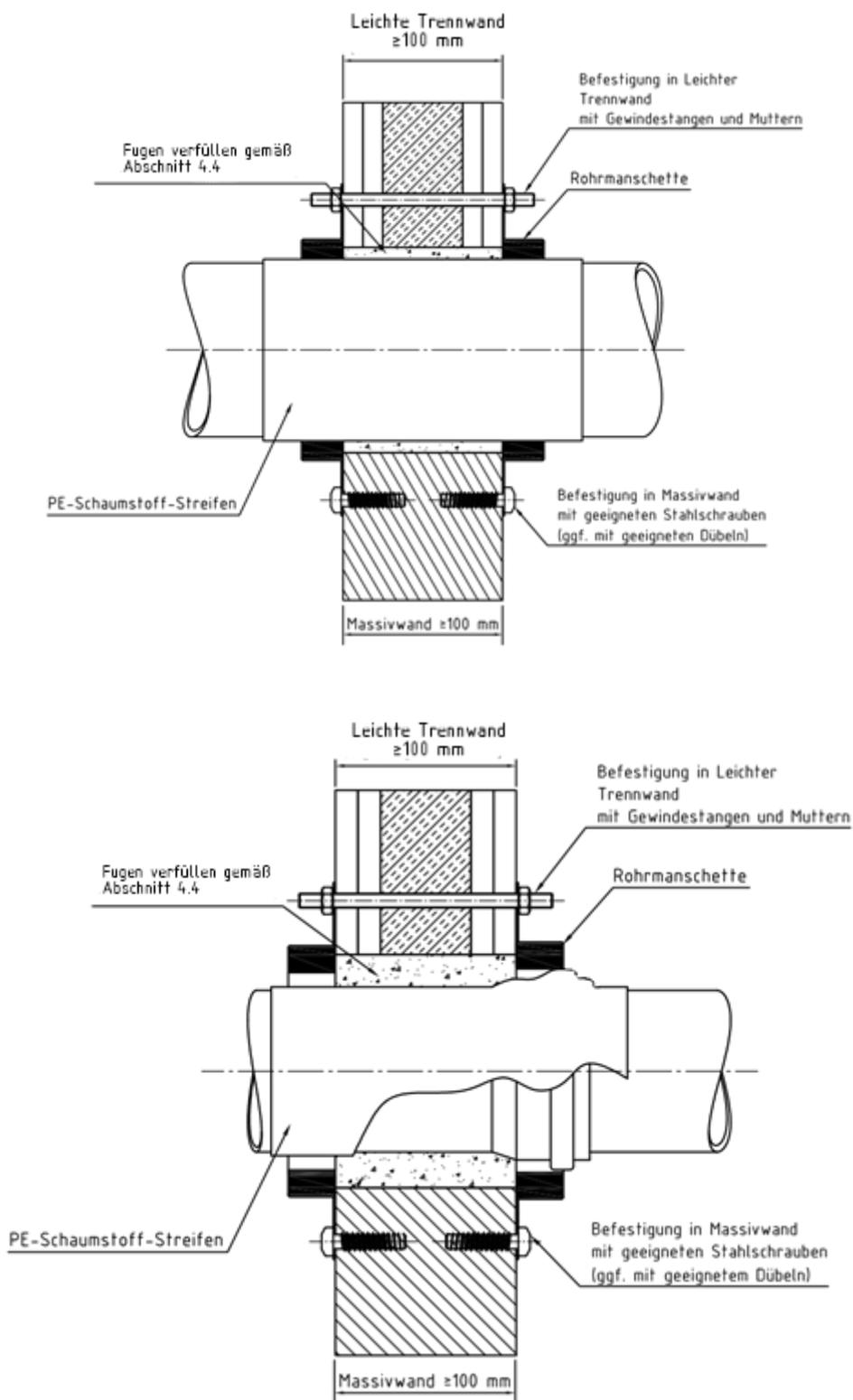
Rohrabschottung "Curaflam System XS<sup>Pro</sup>" bzw. "System FS-M R1"
