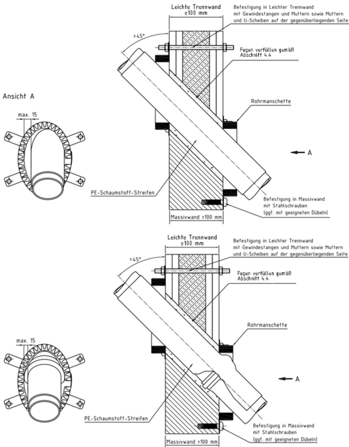
Rohrabschottung "Curaflam System XS<sup>Pro</sup>" bzw. "System FS-M R1" der Feuerwiderstandsklasse R 90 nach DIN 4102-11
