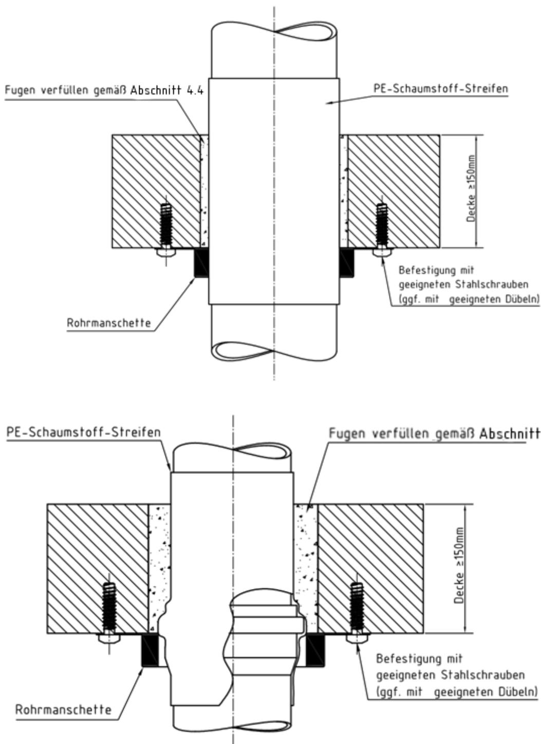
Rohrabschottung "Curaflam System XS<sup>Pro</sup>" bzw. "System FS-M R1"
