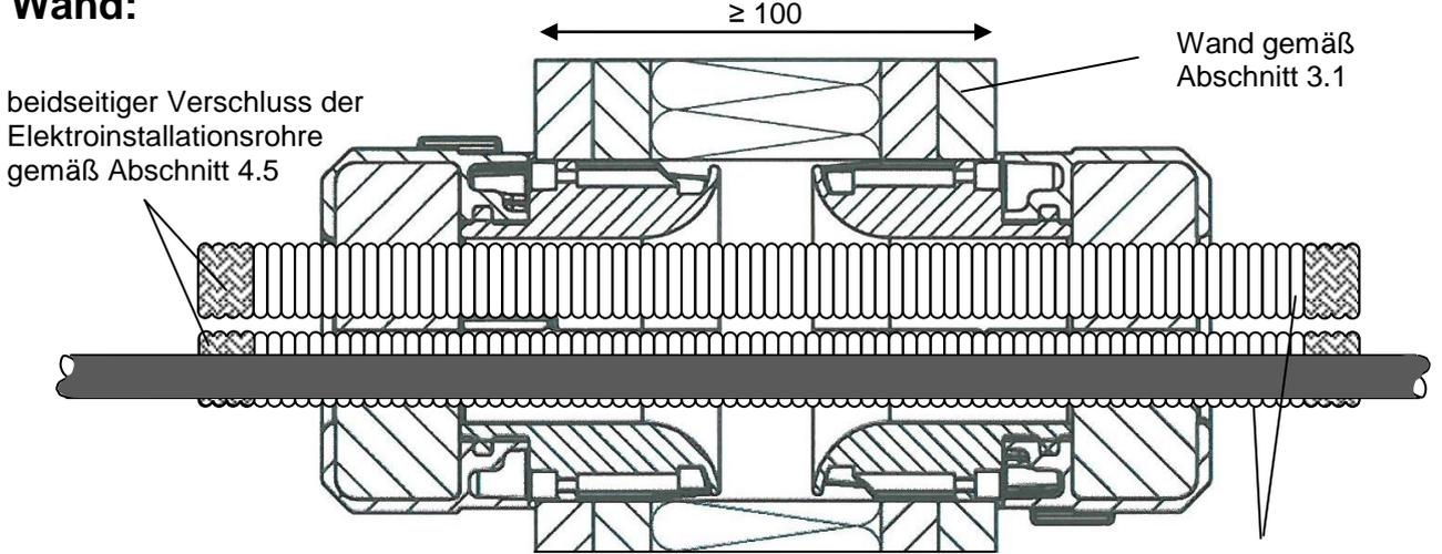
Stopfen für Elektro-Installationsrohre
