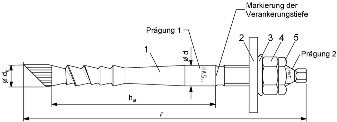
Prägung 1: Typ-Ankerstange HAS-TZ bzw. HAS-HCR-TZ } z.B. HAS-TZ M12/50
