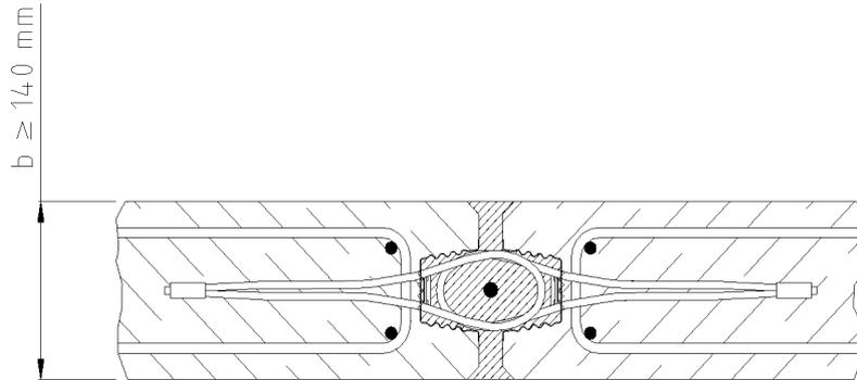
Bild 4: Wand - Wandverbindung
