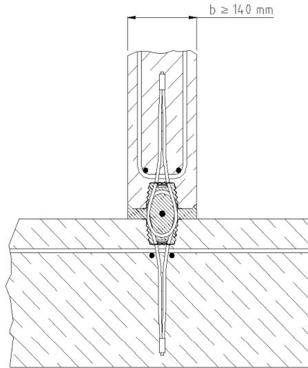
Bild 8: Wand – Wand – T-Verbindung - Regeldetail
