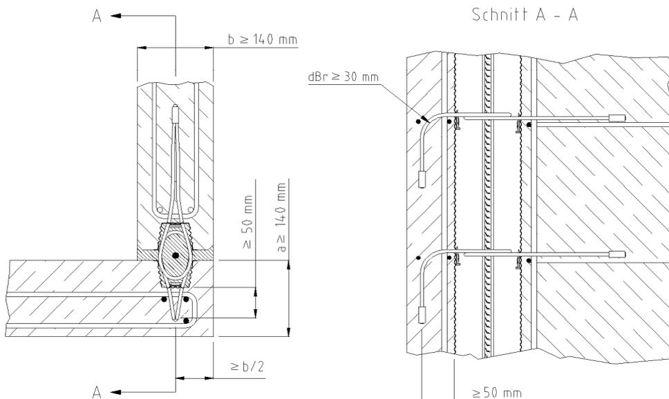
Bild 7: Wand – Wand – Eckverbindung - Detail bei abgewinkelter Seilschleufe
