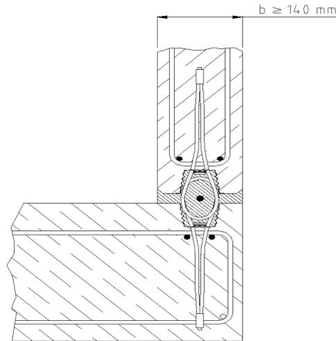
Bild 6: Wand – Wand – Eckverbindung - Regeldetail
