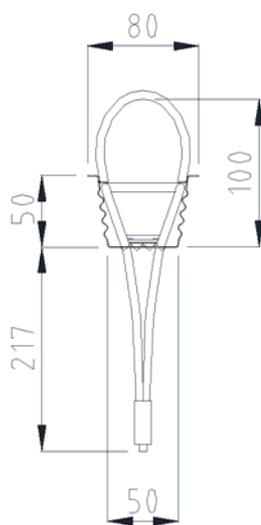
Bild 2: VS<sup>®</sup>-BZ-50 (Querschnitt)
