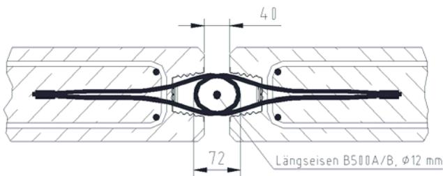
Bild 13: Maximale Fugenbreite
