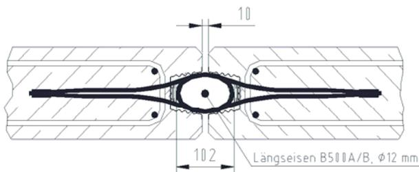
Bild 12: Minimale Fugenbreite
