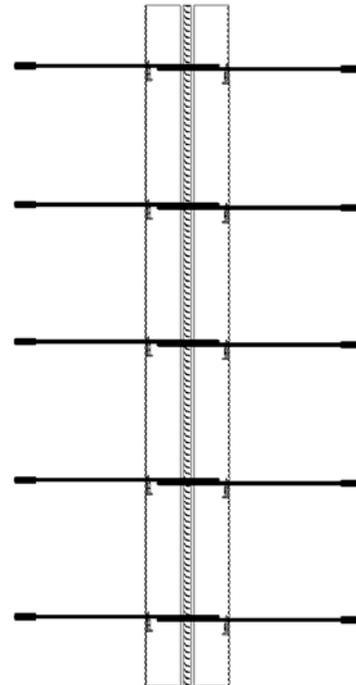
Bild 14: Regelfall Schlaufenüberlappung
