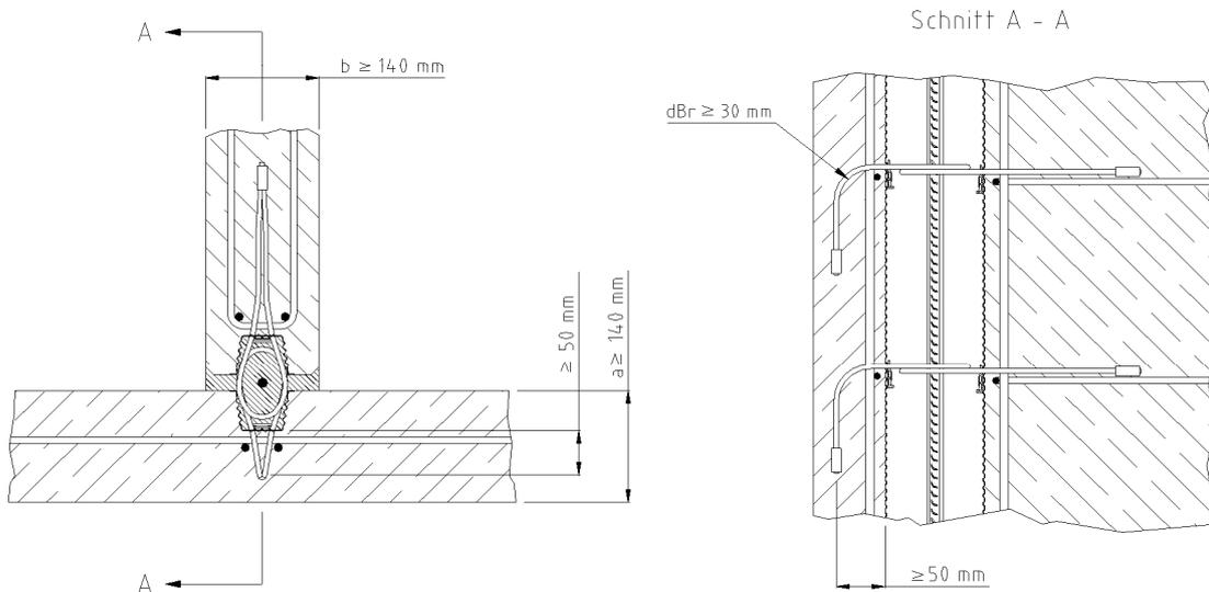
Bild 9: Wand – Wand – T-Verbindung - Detail bei abgewinkelter Seilschleife
