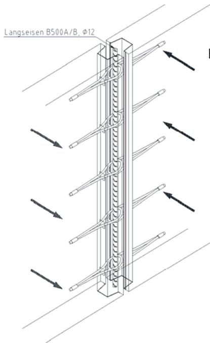
Bild 18: Beanspruchung senkrecht zur Fugenlängsrichtung und Wandebene
