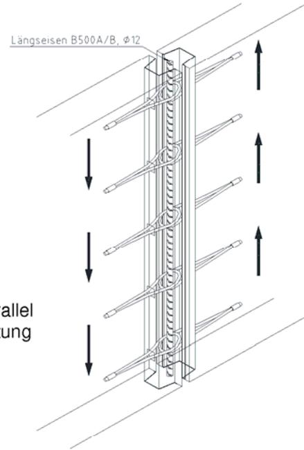
Bild 17: Beanspruchung parallel zur Fugenlängsrichtung
