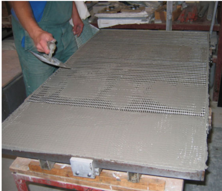
Bild 1: Herstellung der Textilbetonplatte im Handlaminierverfahren
