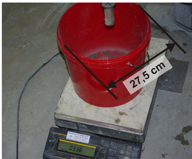
Bild 4: Versuchsanordnung zur Einstellung des Mantelluft-Drucks
