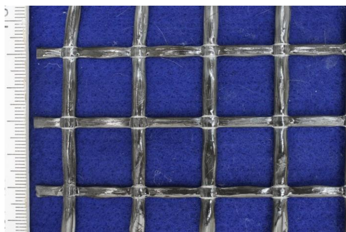
Bild 1: Beschichtete Textilbewehrung "Quinting Grid"
