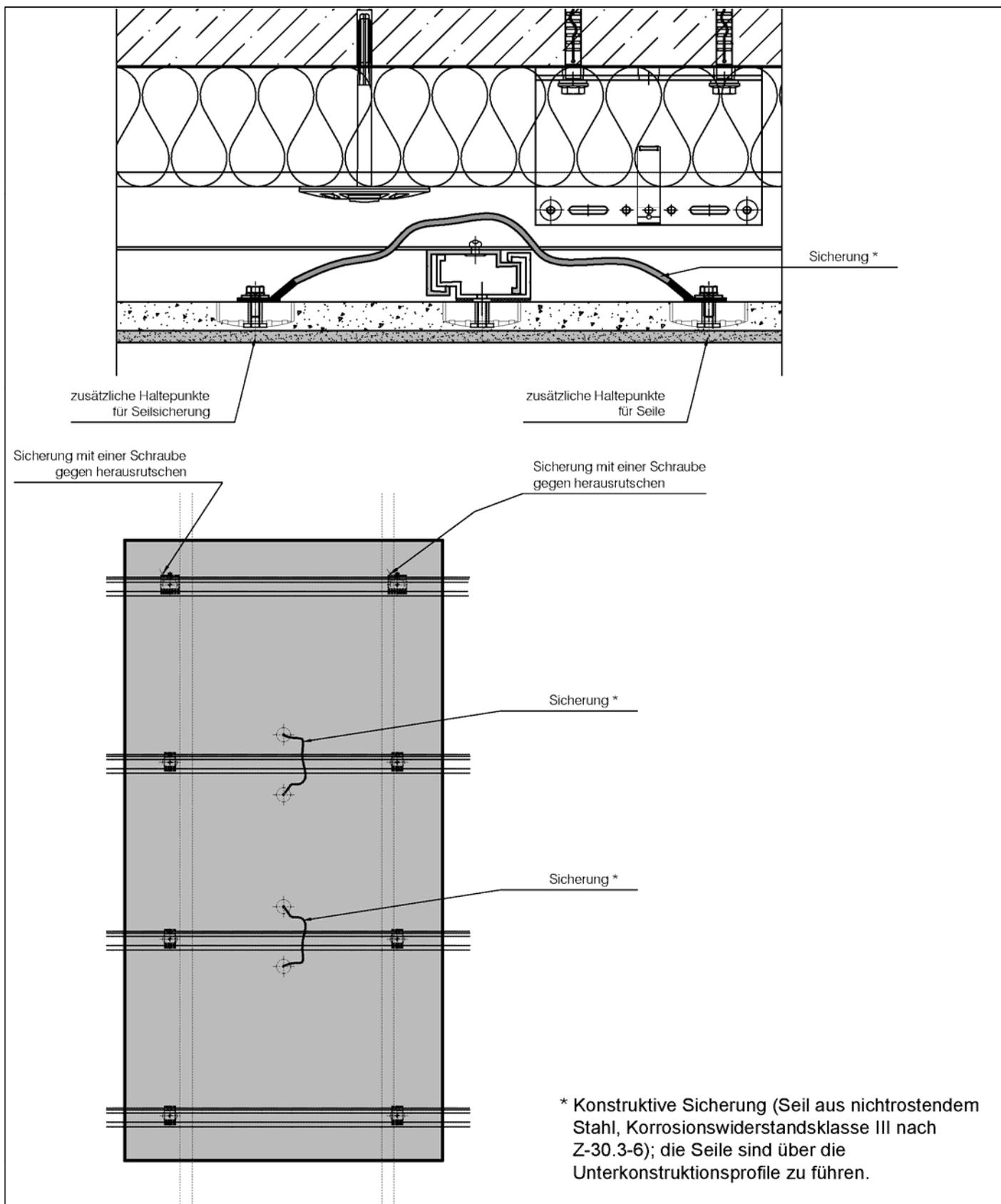
Vorgehängte, hinterlüftete Außenwandbekleidung und außenseitige Fassadenuntersicht "Airtec Glass"
