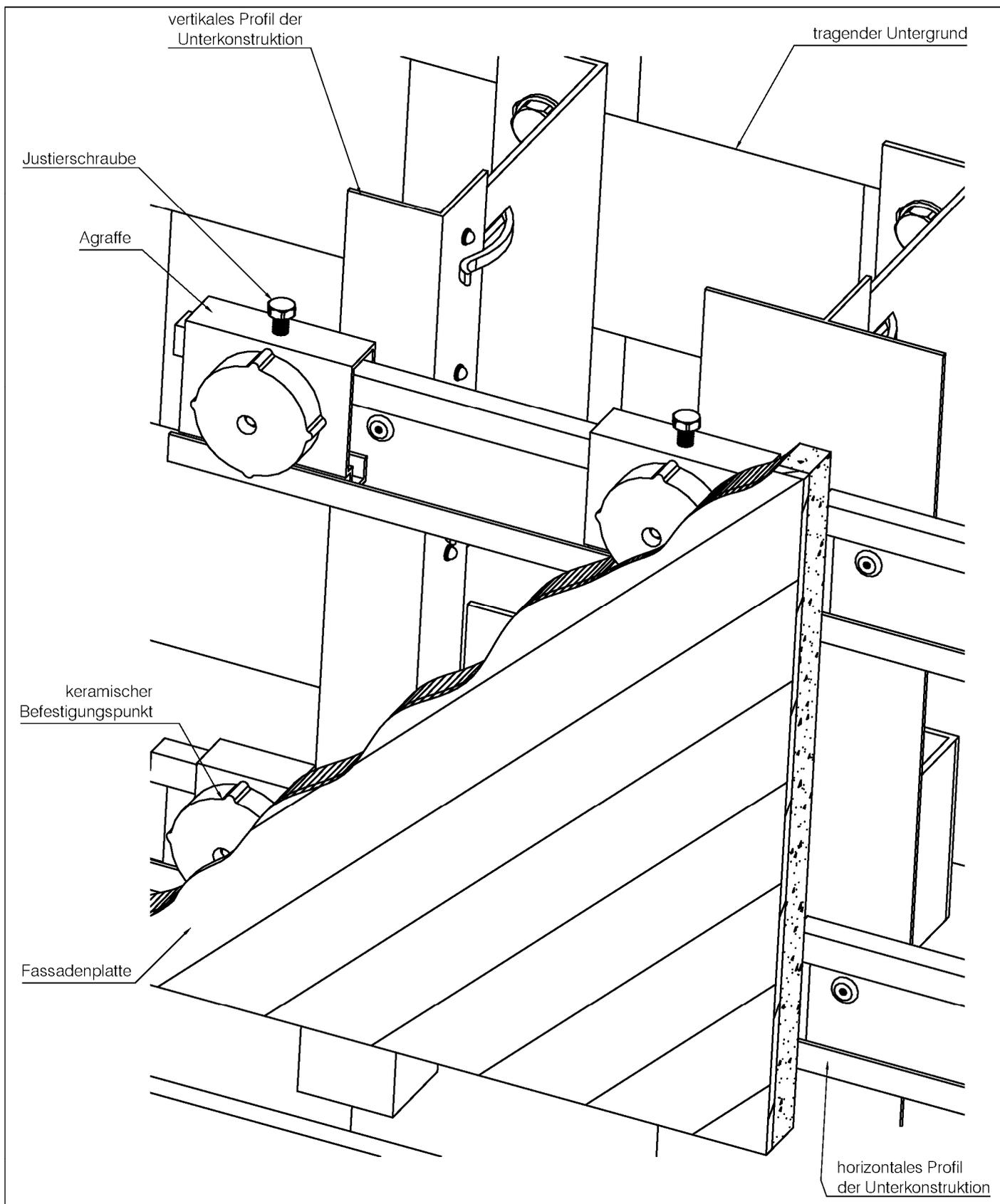
Vorgehängte, hinterlüftete Außenwandbekleidung und außenseitige Fassadenuntersicht
