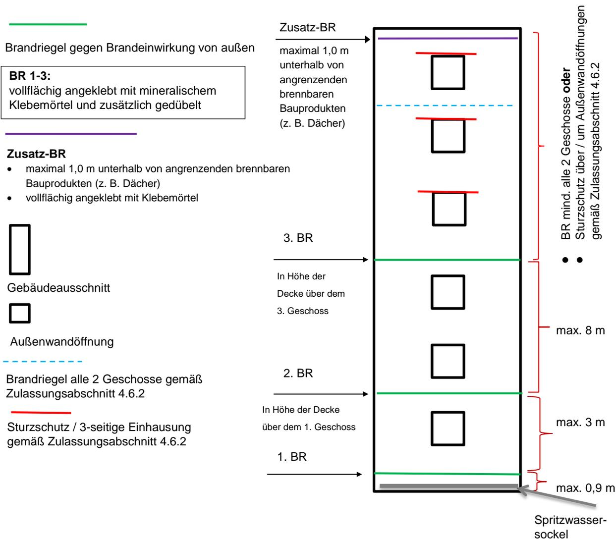
Wärmedämm-Verbundsysteme mit angeklebten EPS-Platten
