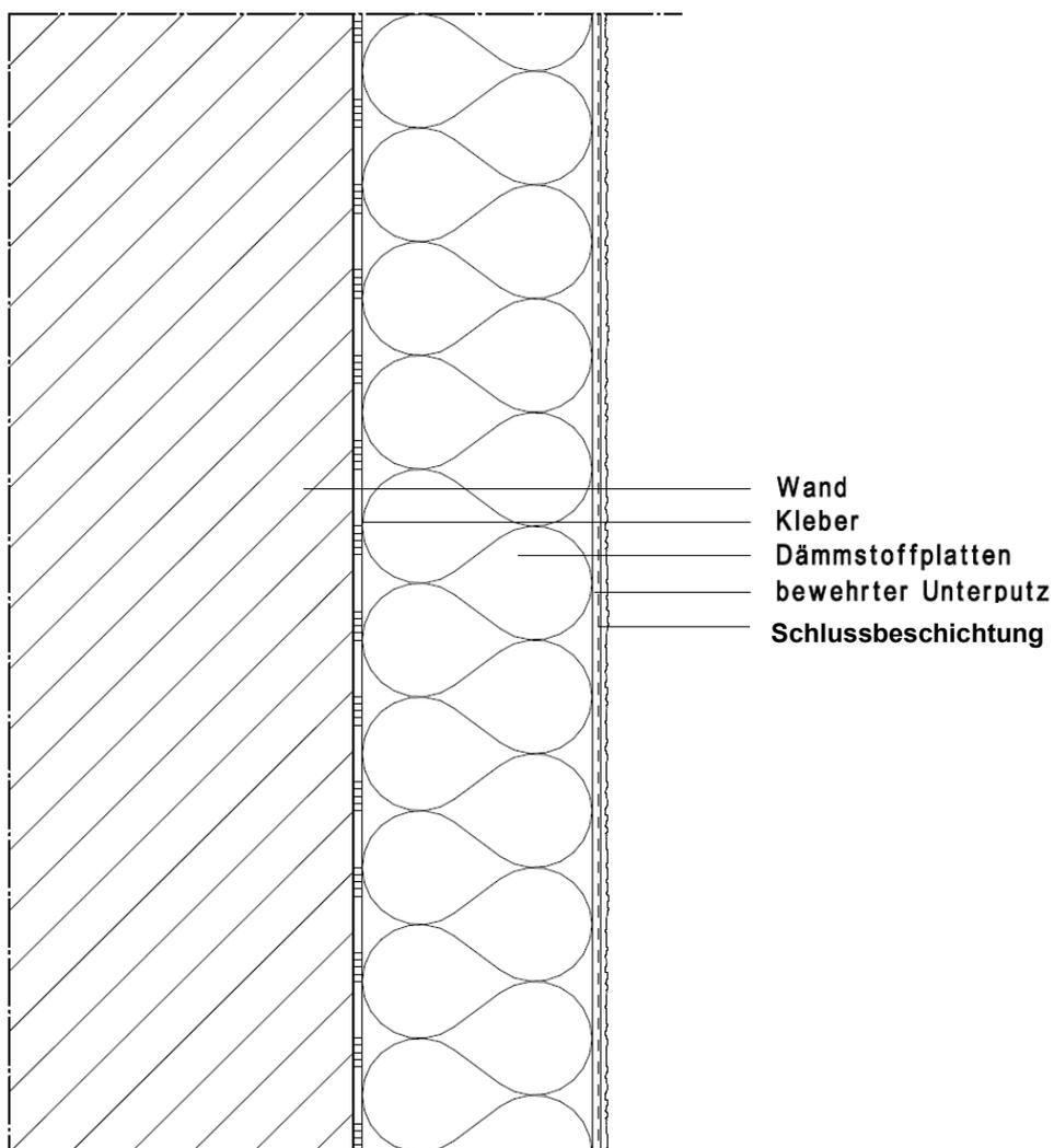
**Wärmedämm-Verbundsystem mit angeklebten
