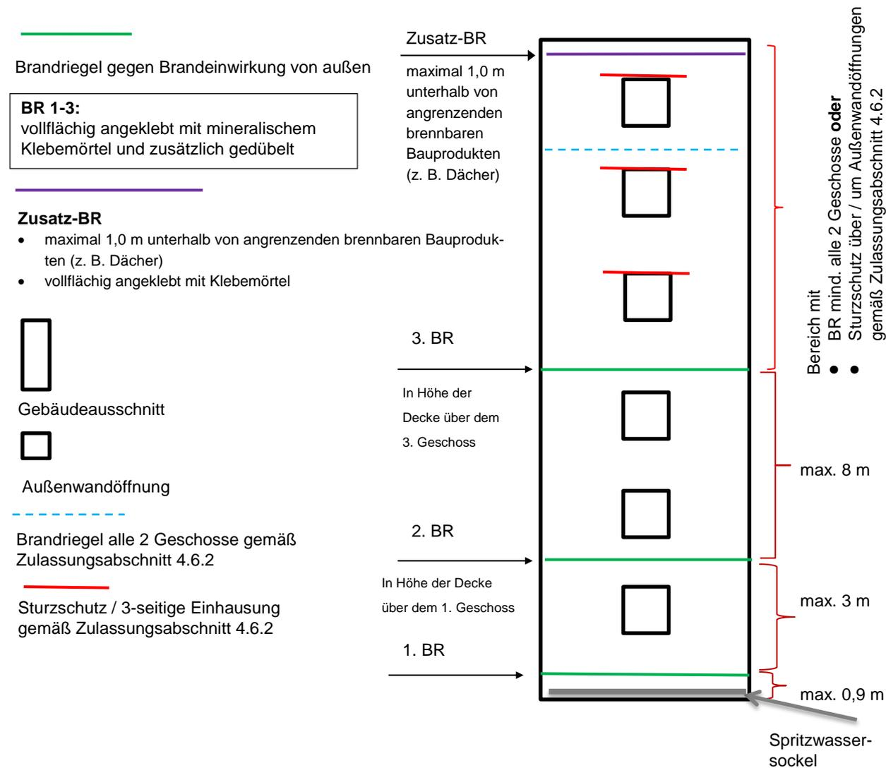
Wärmedämm-Verbundsysteme mit angeklebten EPS-Platten
