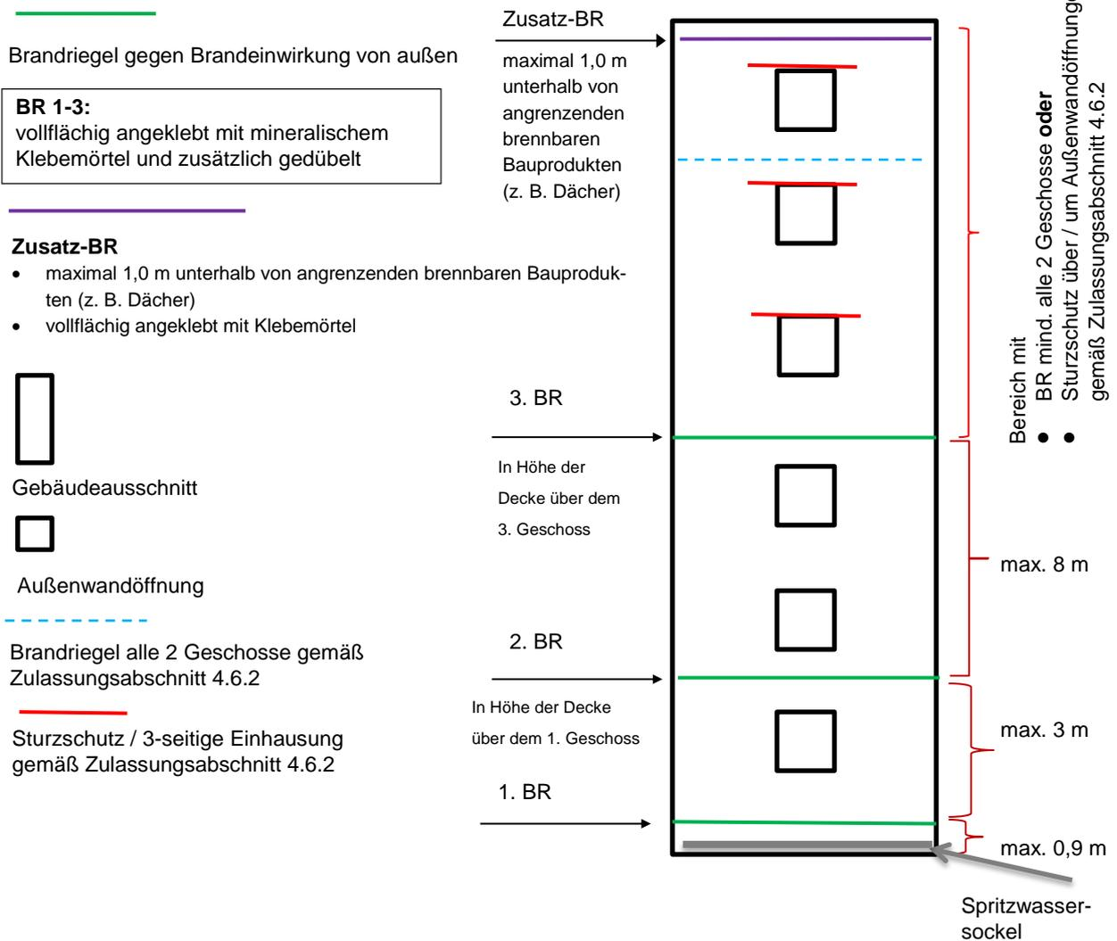
Wärmedämm-Verbundsystem mit angeklebten EPS-Platten
