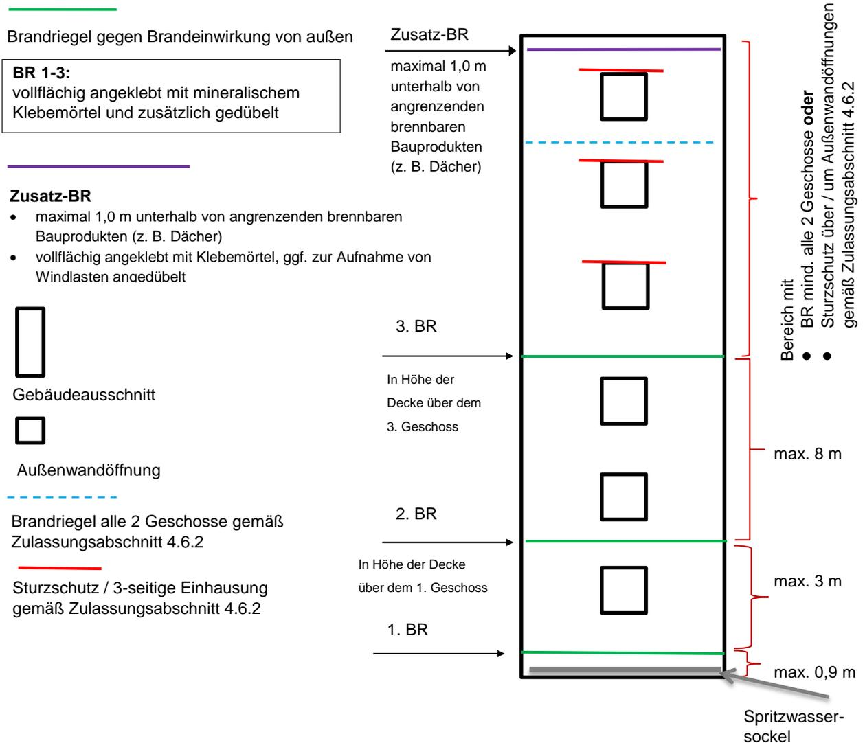
**Wärmedämm-Verbundsystem mit angeklebten und
