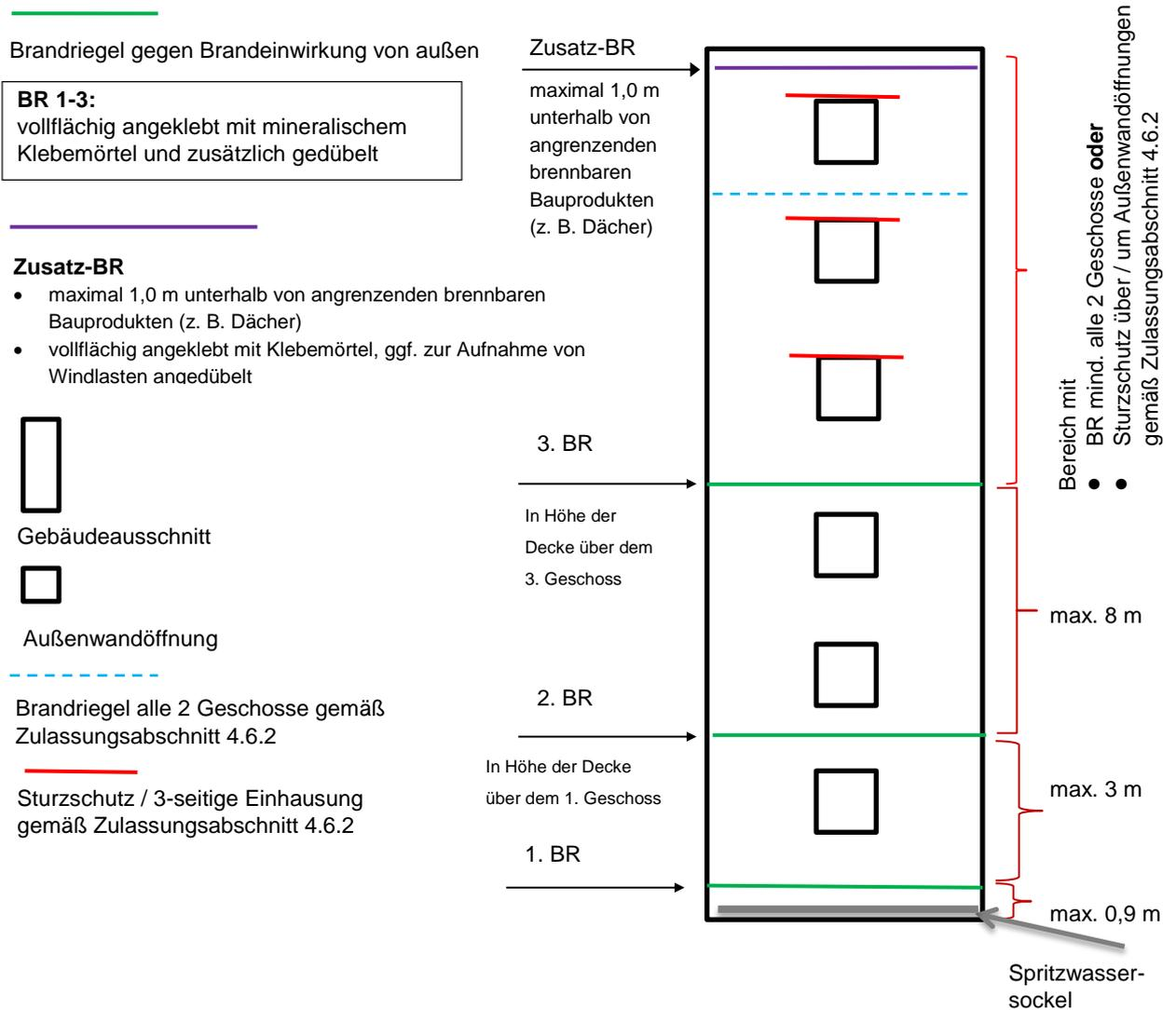
**Wärmedämm-Verbundsystem mit angeklebten und
