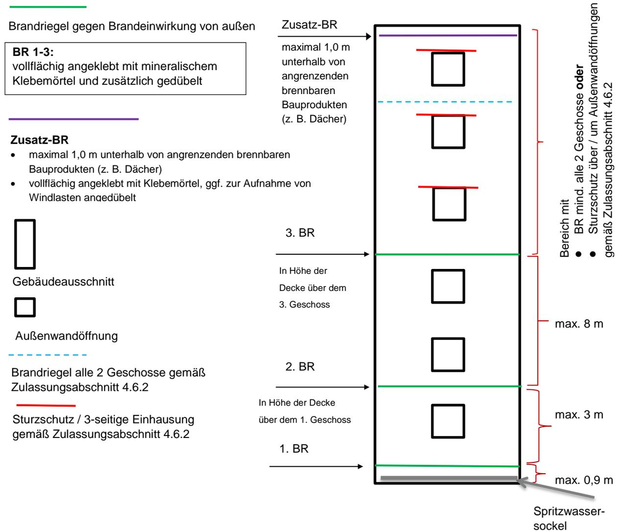
Wärmedämm-Verbundsystem mit angeklebten und angedübelten EPS-Platten über 300 mm bis 360 mm
