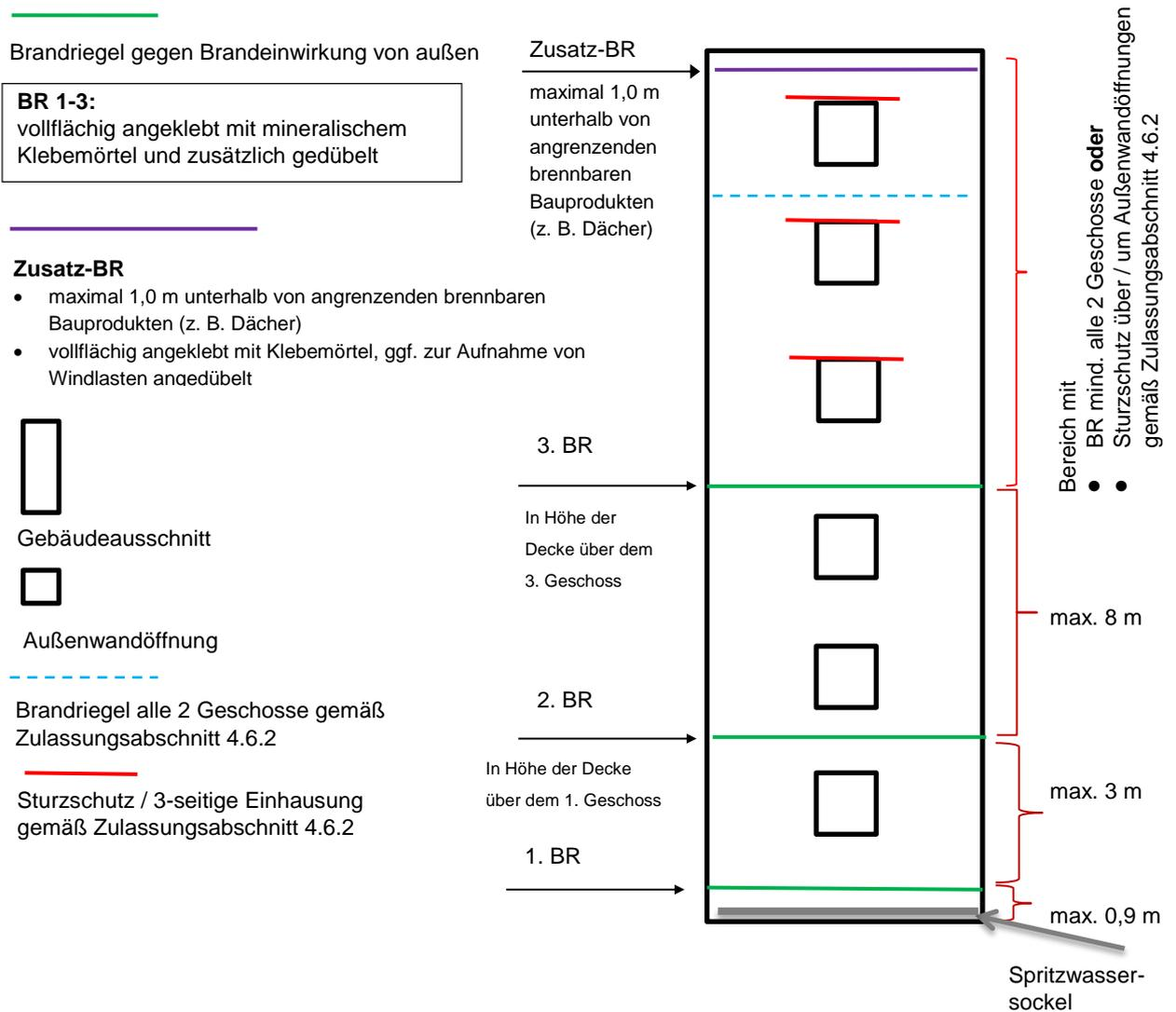
Wärmedämm-Verbundsystem mit angeklebten und angedübelten EPS-Platten bis max. 300 mm bis 360 mm
