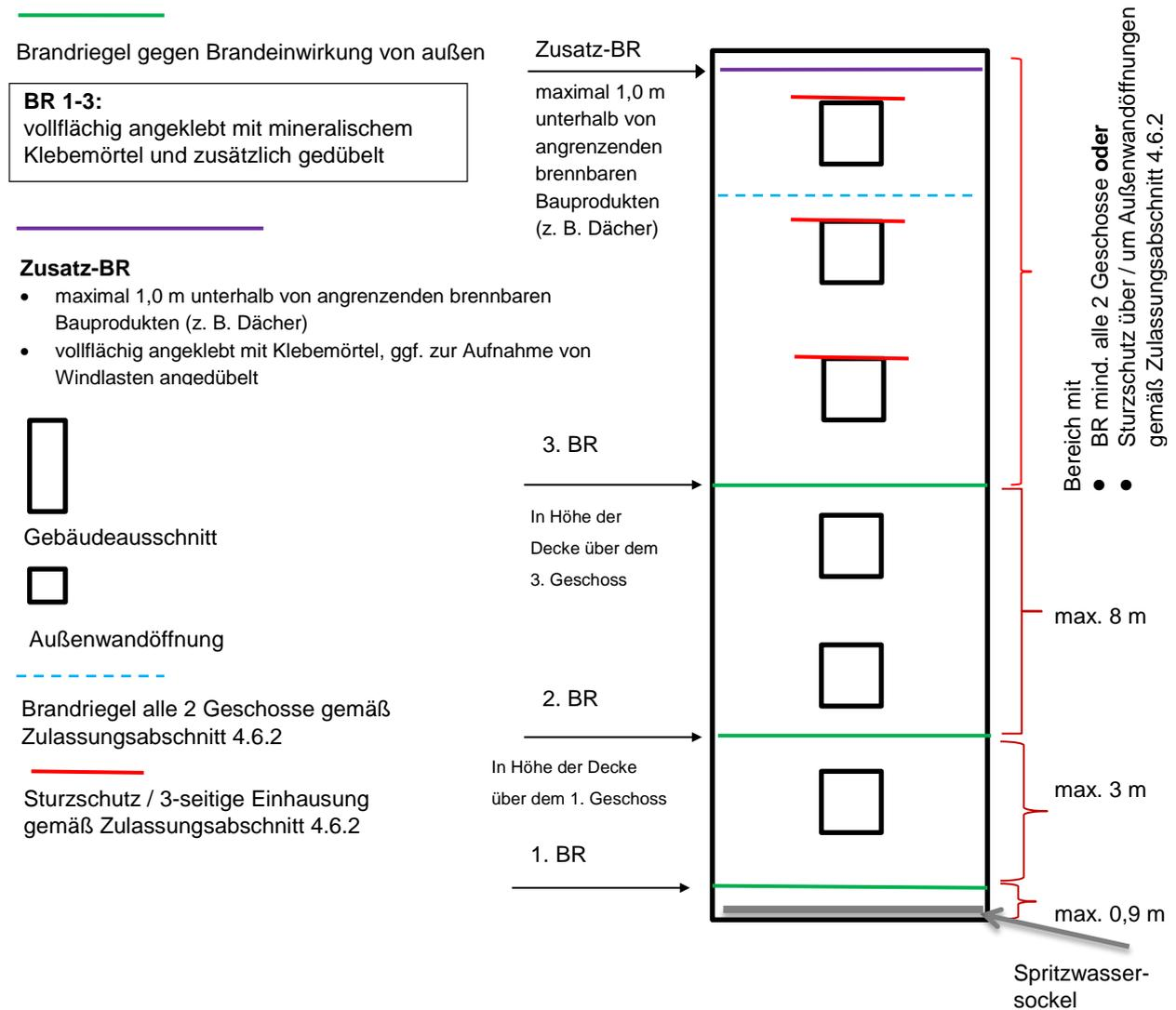
Wärmedämm-Verbundsystem mit angeklebten und angedübelten EPS-Platten über 300 mm bis max. 400 mm
