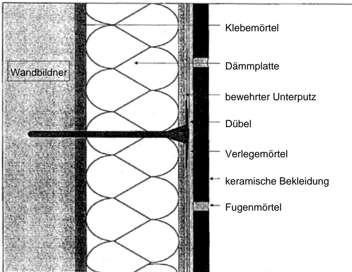
Wärmedämm-Verbundsysteme mit angeklebter Bekleidung      Anlage 2
