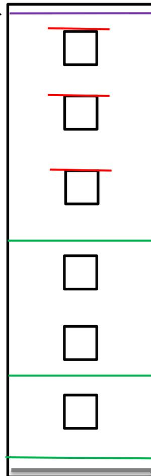
Bereich des Fugenleit-WDVS mit Sturzschutz bzw. 3-seitiger Einhausung über / um Außenwandöffnungen gemäß Zulassungsabschnitt 4.6.2
