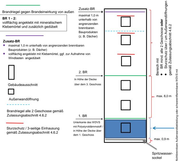
nichtbrennbare Autsenwandbekleidung oder schwerentillanmbares w DVS mit nichtbrennbarer Mineralwolle-Dämmung, oberhalb Spritzwassersockel über Geländeoberkante, bis zur Höhe der Decke über dem 1. Geschoss, jedoch mind. 3 m
