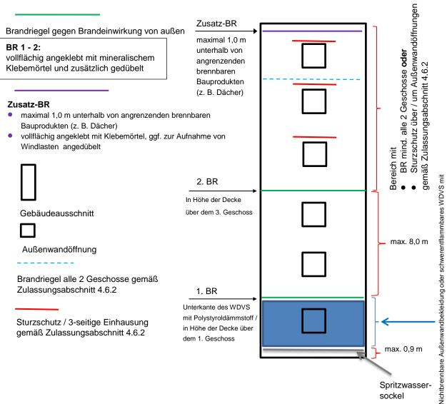
nichtbrennbarer Mineralwolle-Dämmung, oberhalb Spritzwassersockel über Geländeoberkante, bis zur Höhe der Decke über dem 1. Geschoss, jedoch mind. 3 m
