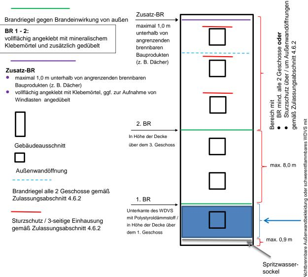
Nichrbrennbare Aussenwandbekleidung oder schwerentilammbares w.D.V.S. mit nichtbrennbarer Mineralwolle-Dämmung, oberhalb Spritzwassersockel über Geländeoberkante, bis zur Höhe der Decke über dem 1. Geschoss, jedoch mind. 3 m
