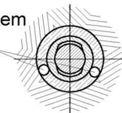
SAS Mikropfähle (Verpresspfähle mit kleinem Durchmesser) mit einem Tragglied aus SAS-Stabstahl mit Gewinderippen SAS 555 (S 555/700); Ø 63,5 mm
