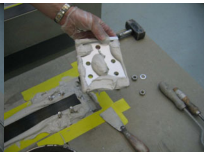
Auf die Deckplatte wird ebenfalls Klebstoff aufgetragen
