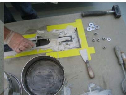
Die Lamelle wird fachgerecht verklebt. Die Endbereiche werden mit Klebstoff beschichtet. Die Abstandhalter werden unter bzw. auf die Lamelle gelegt
