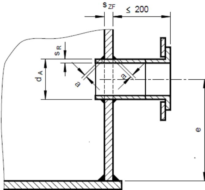
$$a \geq 0,7 \cdot \min(s_{ZF}, s_R) \quad (\text{WE, WZ})$$
