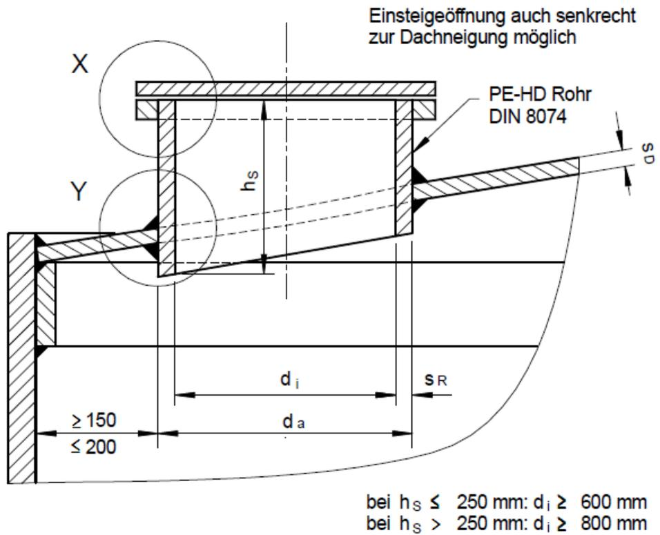
Für kleine Behälterdurchmesser ist eine Anordnung der Einsteigeöffnung über der Kegelspitze zulässig.
