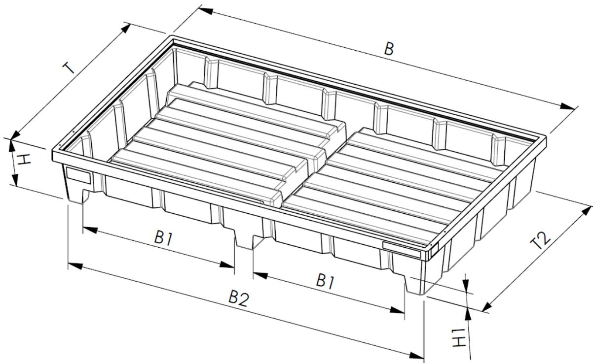
Werkstoff: PE-LLD rotationsgeformt
