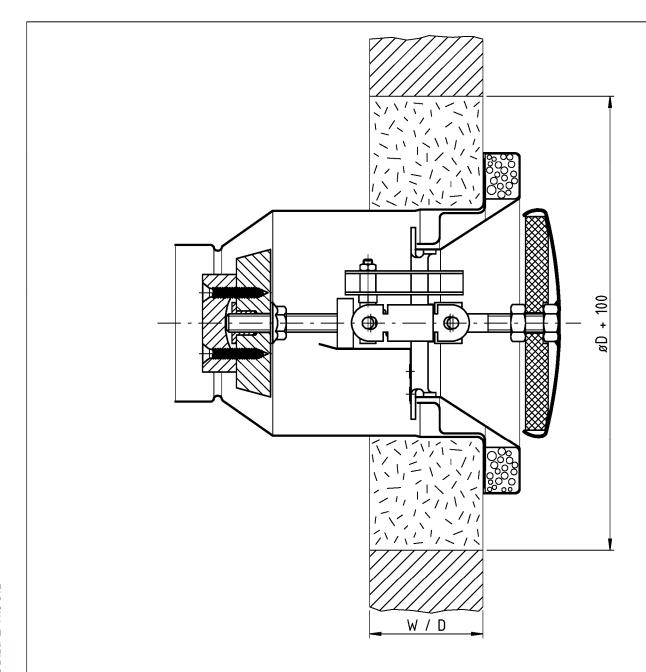
Wand- und Deckeneinbau mit Mörtelgruppe II oder III DIN 1053 oder Beton.
