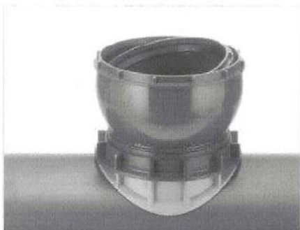
CONNEX®-Anschluss DN/OD 160/162 an HS®-Kanalrohr, Bohrung 162 ± 1 mm
