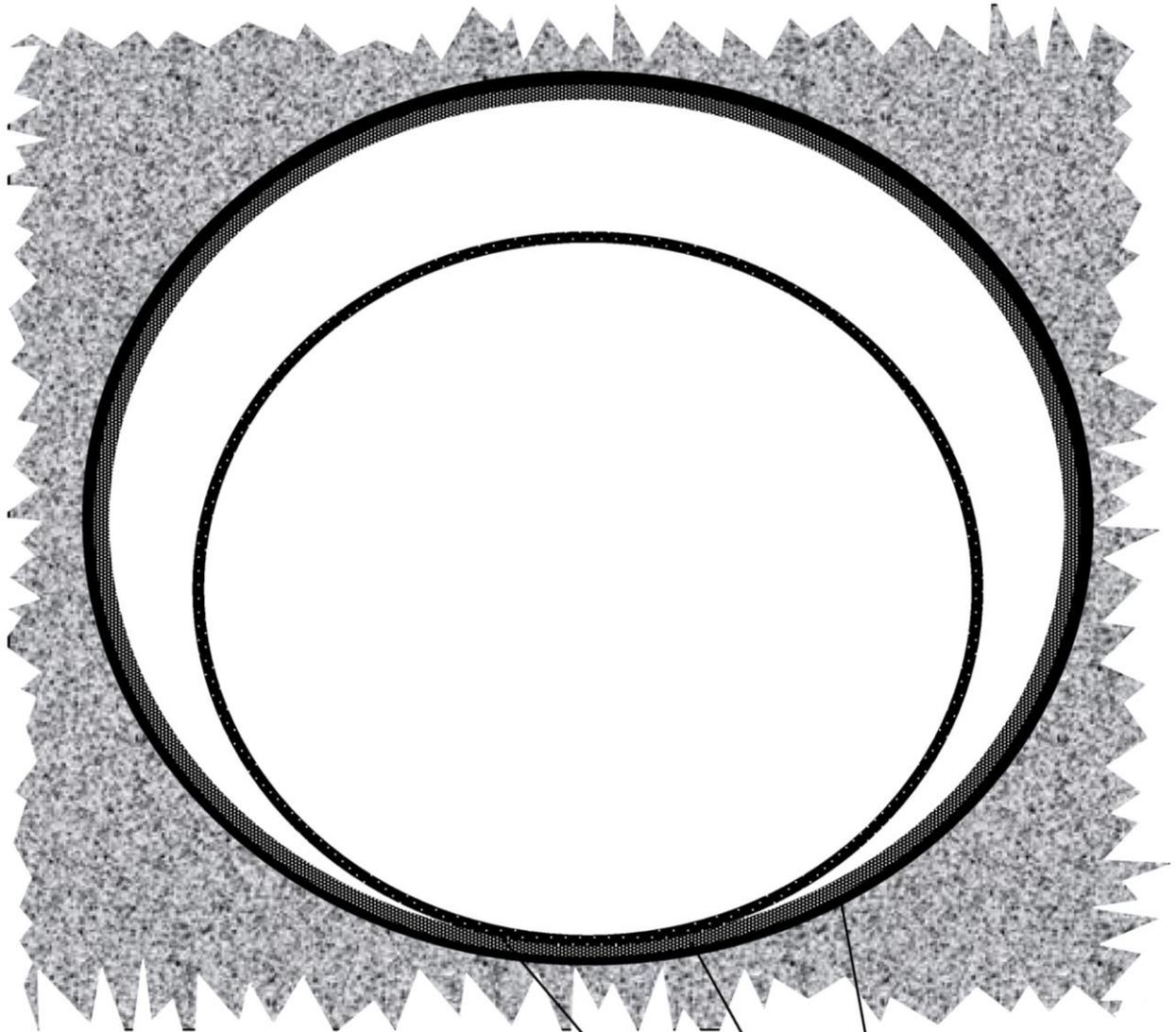
der Liner wird nach dem Einziehen mit Druckluft aufgestellt;
