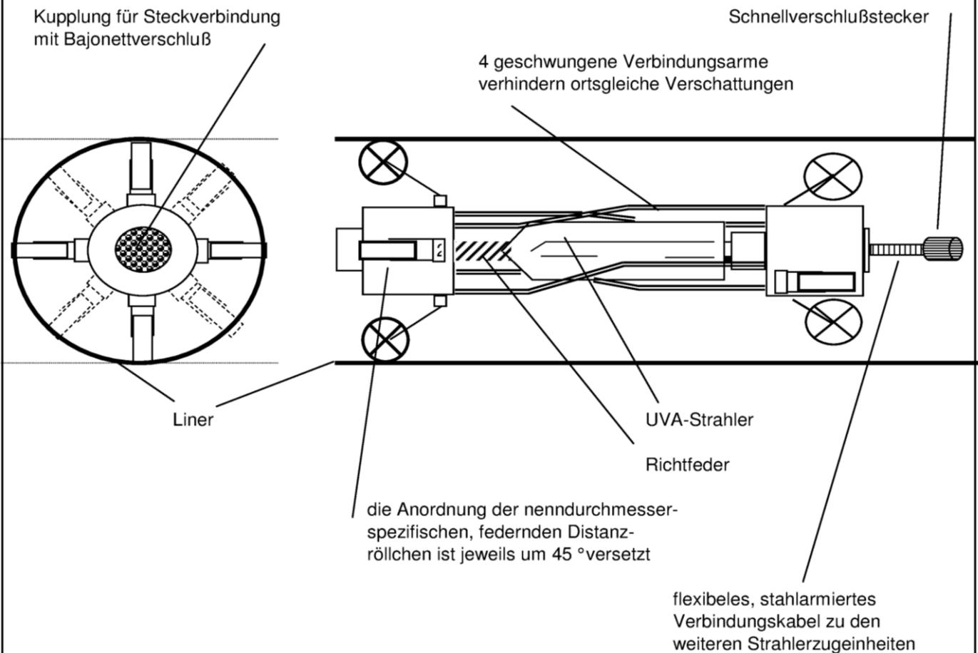
Schlauchlinierverfahren mit der Bezeichnung "Berolina Liner" und "Berolina HF Liner" zur Sanierung von erdverlegten schadhafte Abwasserleitungen mit Kreisprofilen in den Nennweiten DN 150 bis DN 1600 und Eiprofilen in den Nennweiten 200/300 mm bis 1200/1800 mm
