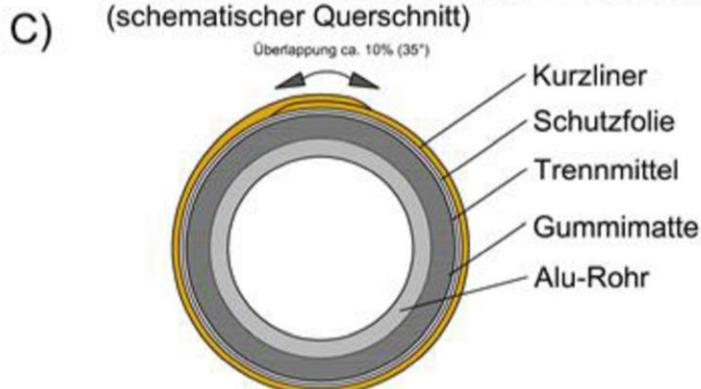
Kurzlinerverfahren "CarboLith Spot Repair System" zur Sanierung erdverlegter
