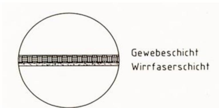
Kurzlinerverfahren "CarboLith Spot Repair System" zur Sanierung erdverlegter
