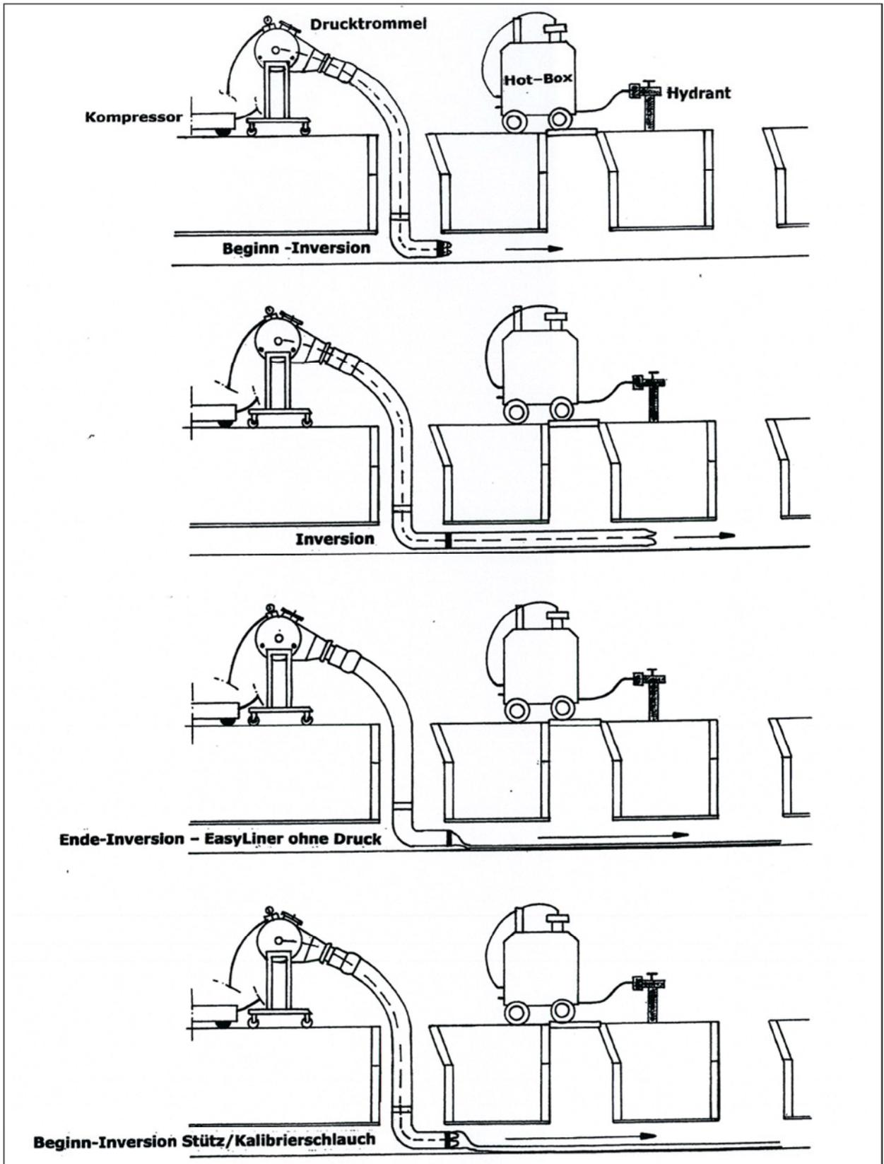
Schlauchlinierverfahren mit der Bezeichnung "EasyLiner" zur Sanierung von erdverlegten Abwasserleitungen im Nennweitenbereich von DN 100 bis DN 300
