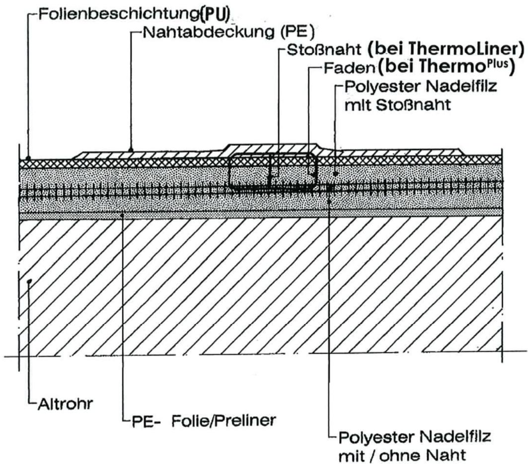
Schlauchlinierverfahren mit der Bezeichnung "EasyLiner" zur Sanierung von erdverlegten Abwasserleitungen im Nennweitenbereich von DN 100 bis DN 300
