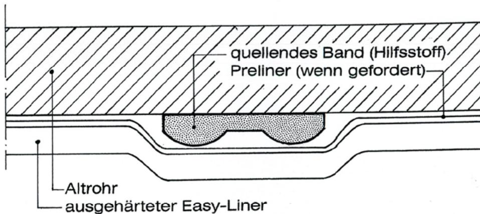
Schlauchlinungsverfahren mit der Bezeichnung "EasyLiner" zur Sanierung von erdverlegten Abwasserleitungen im Nennweitenbereich von DN 100 bis DN 300
