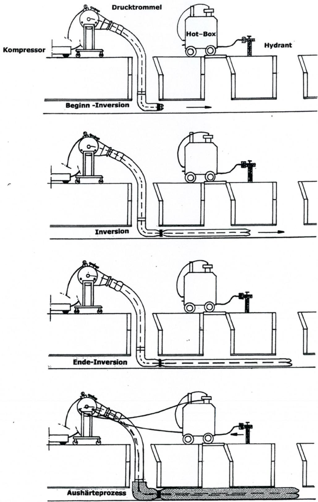
Schlauchliningverfahren mit der Bezeichnung "EasyLiner" zur Sanierung von erdverlegten Abwasserleitungen im Nennweitenbereich von DN 100 bis DN 300
