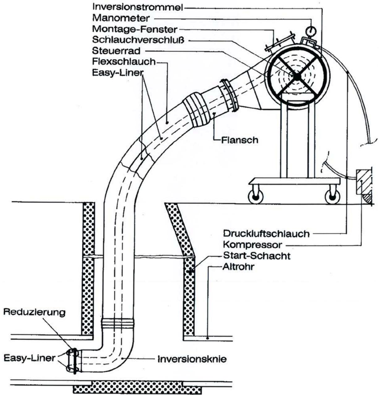
Schlauchlinungsverfahren mit der Bezeichnung "EasyLiner" zur Sanierung von erdverlegten Abwasserleitungen im Nennweitenbereich von DN 100 bis DN 300
