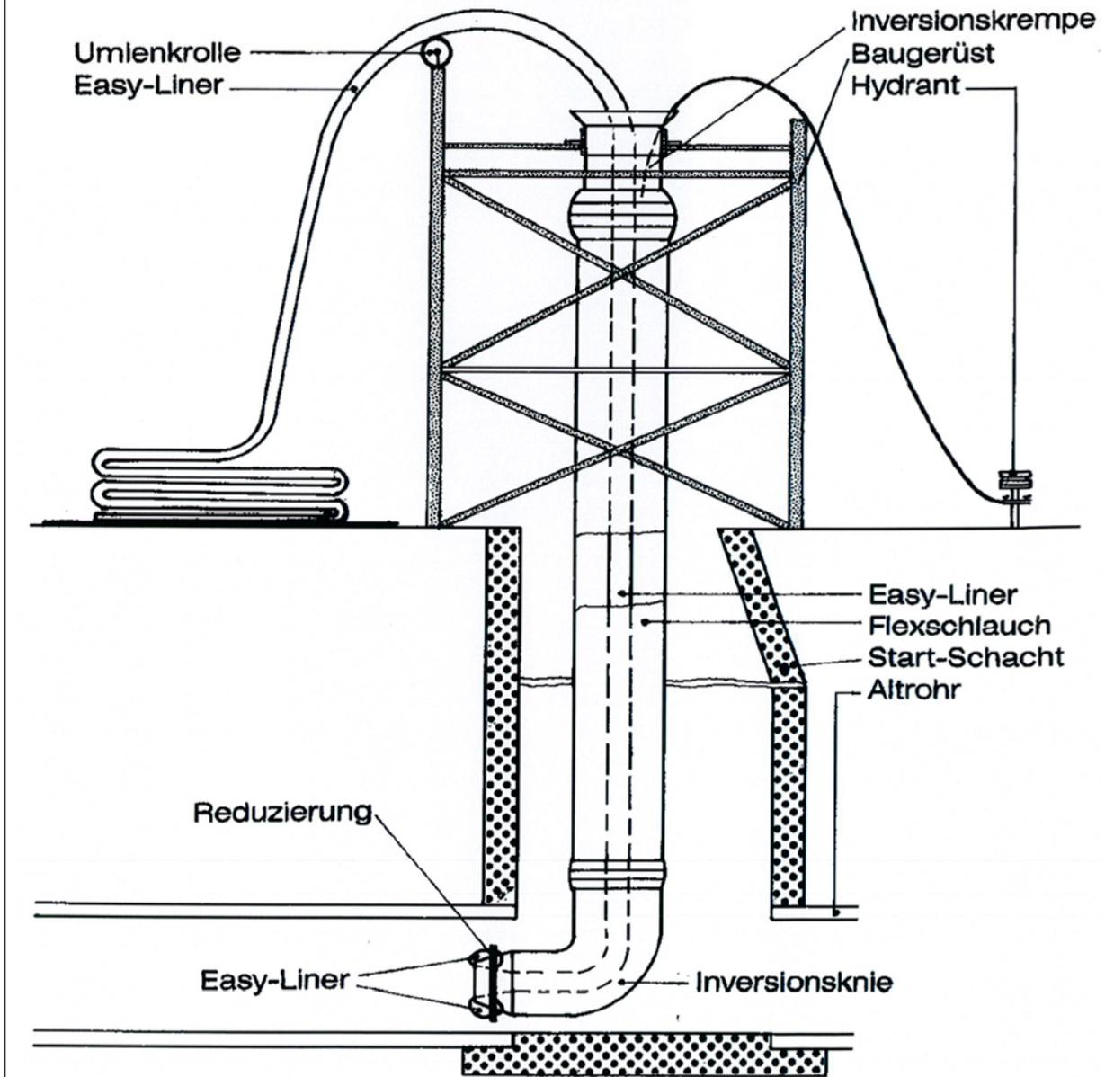
Schlauchlinierverfahren mit der Bezeichnung "EasyLiner" zur Sanierung von erdverlegten Abwasserleitungen im Nennweitenbereich von DN 100 bis DN 300
