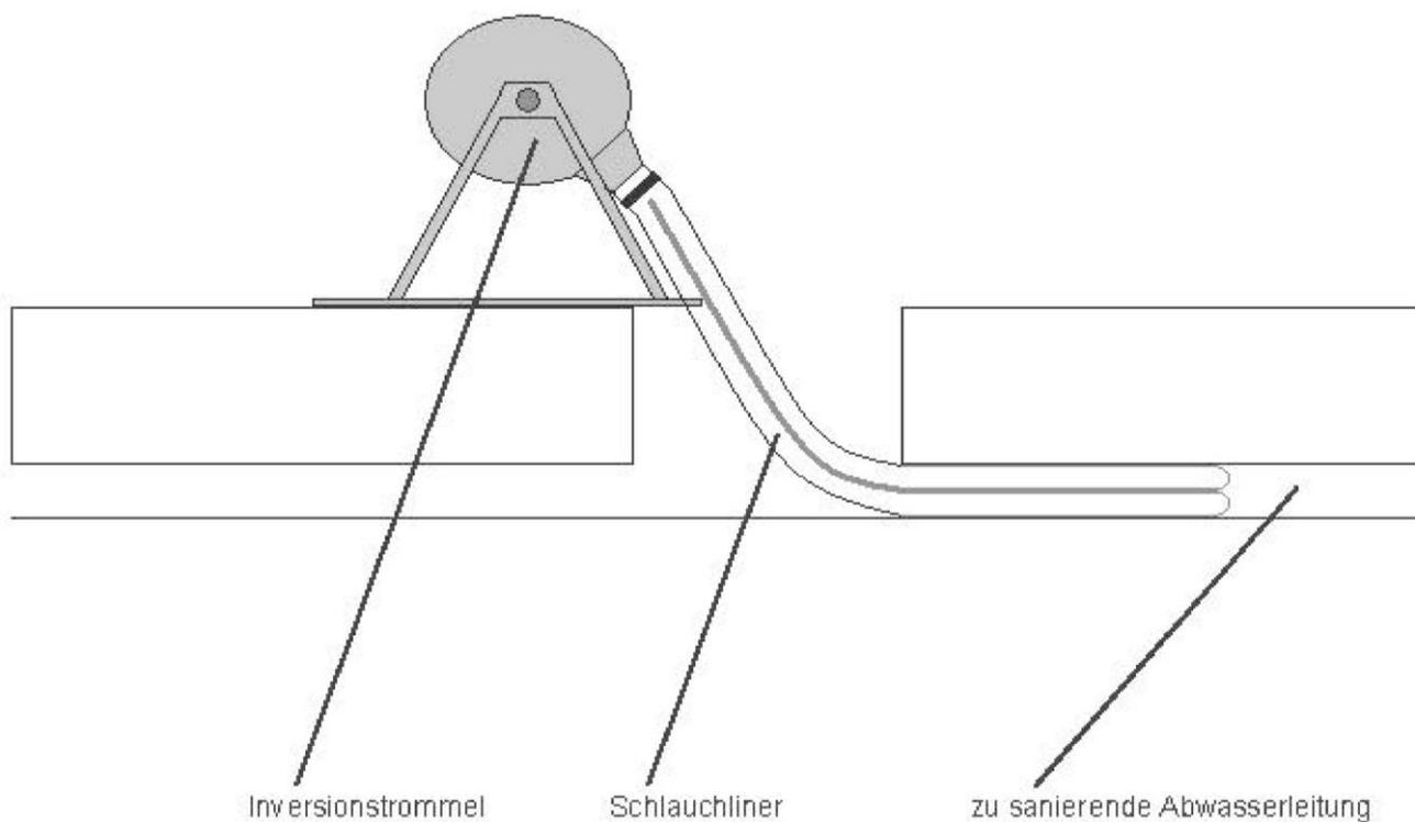
**Schlauchlinierverfahren mit der Bezeichnung "RS MaxLiner® S" für die Sanierung erdverlegter Abwasserleitungen im Nennweitenbereich von DN 100 bis DN 400**
