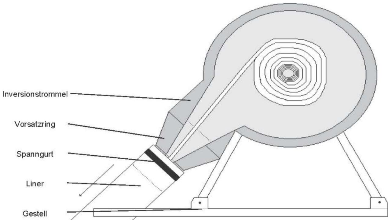
Schlauchliningverfahren mit der Bezeichnung "RS MaxLiner® S" für die Sanierung erdverlegter Abwasserleitungen im Nennweitenbereich von DN 100 bis DN 400
