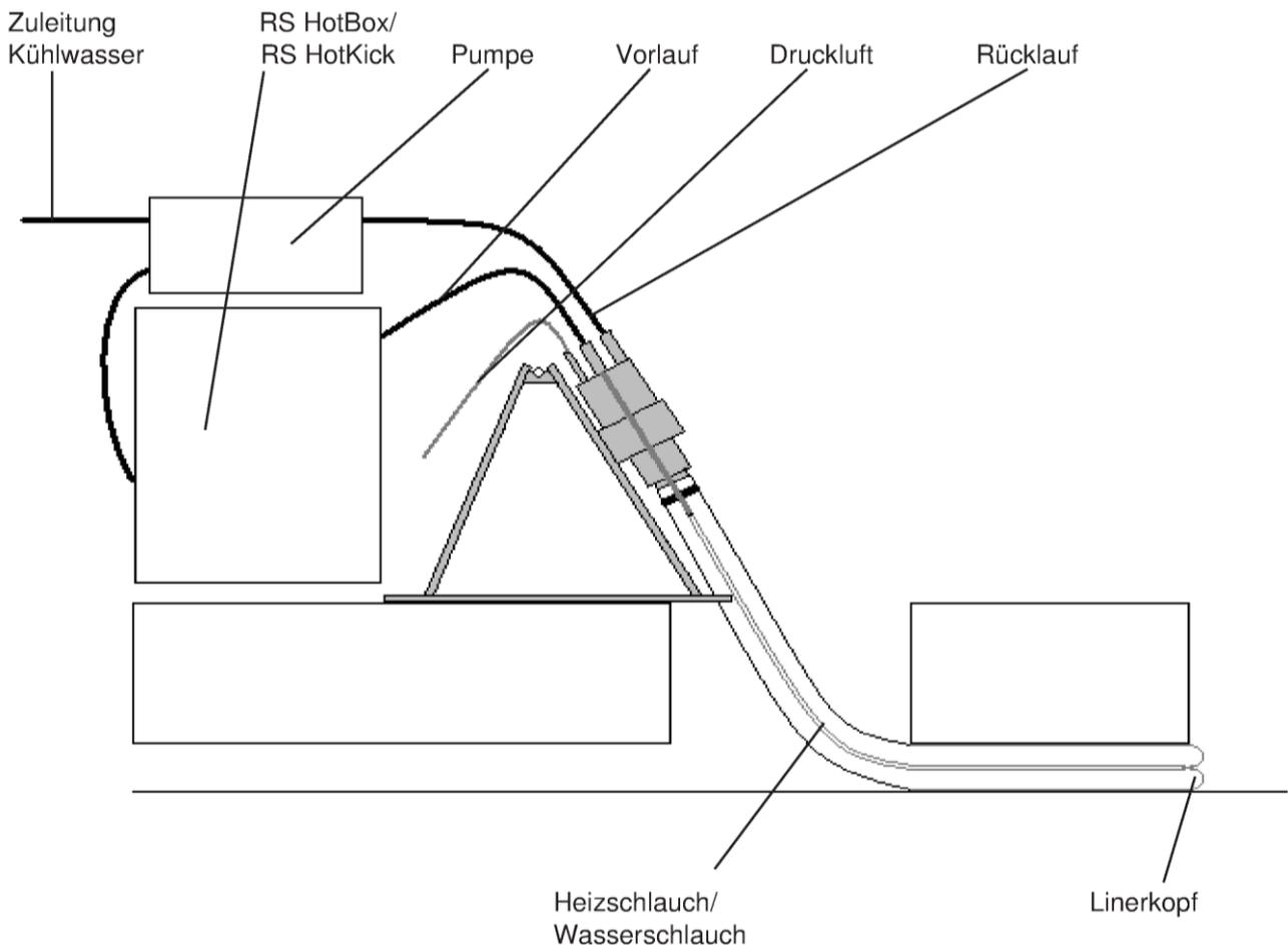
Schlauchlinierverfahren mit der Bezeichnung "RS MaxLiner® S" für die Sanierung erdverlegter Abwasserleitungen im Nennweitenbereich von DN 100 bis DN 400
