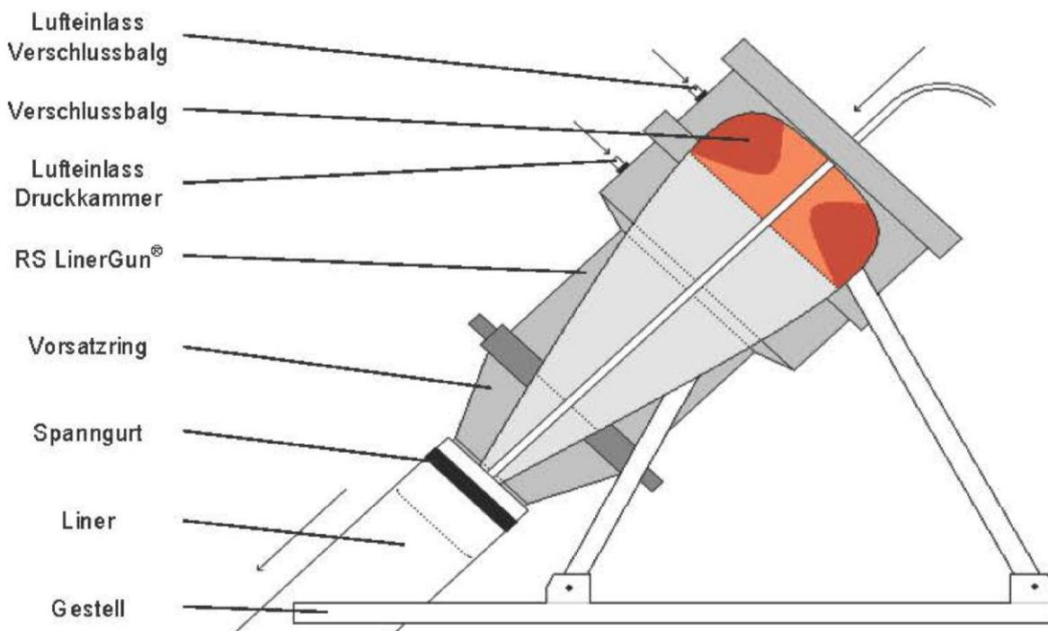
Schlauchlinierverfahren mit der Bezeichnung "RS MaxLiner® S" für die Sanierung erdverlegter Abwasserleitungen im Nennweitenbereich von DN 100 bis DN 400
