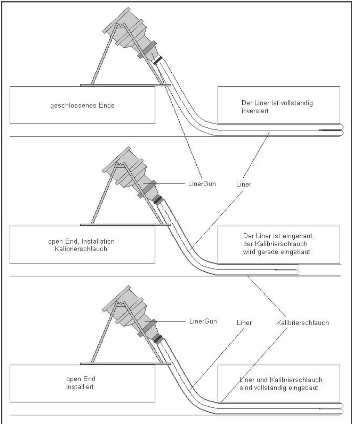
**Schlauchliningverfahren mit der Bezeichnung "RS MaxLiner® S" für die Sanierung erdverlegter Abwasserleitungen im Nennweitenbereich von DN 100 bis DN 400**
