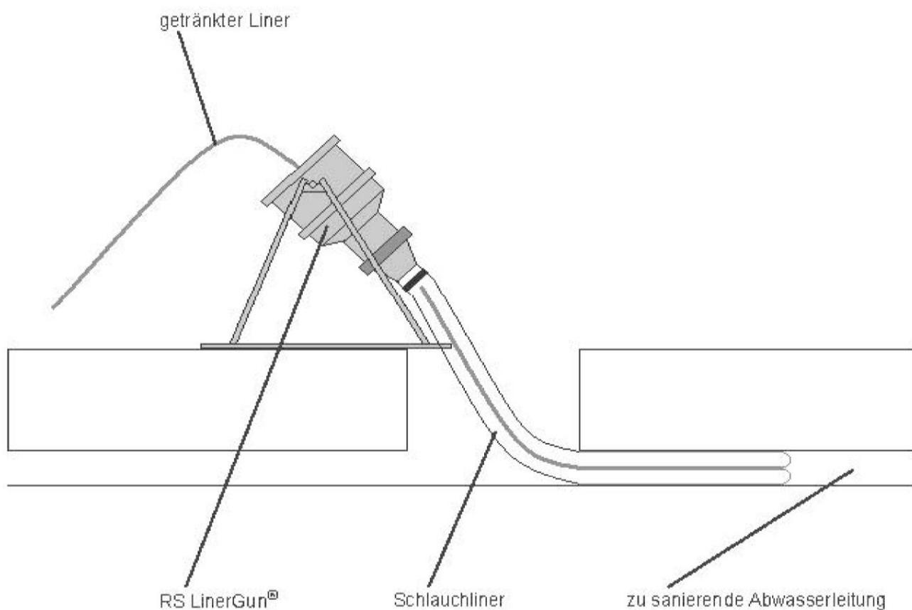
**Schlauchlinierverfahren mit der Bezeichnung "RS MaxLiner<sup>®</sup> S" für die Sanierung erdverlegter Abwasserleitungen im Nennweitenbereich von DN 100 bis DN 400**
