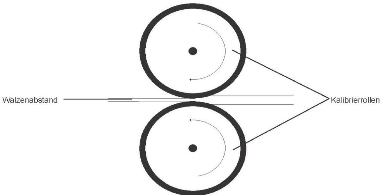
Schlauchlinierverfahren mit der Bezeichnung "RS MaxLiner® S" für die Sanierung erdverlegter Abwasserleitungen im Nennweitenbereich von DN 100 bis DN 400
