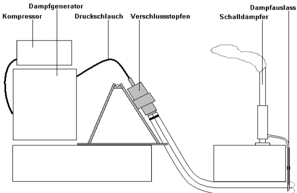
Schlauchliningverfahren mit der Bezeichnung "RS MaxLiner® S" für die Sanierung erdverlegter Abwasserleitungen im Nennweitenbereich von DN 100 bis DN 400
