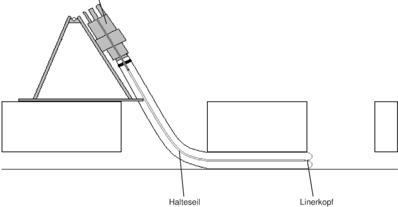
Schlauchlinierverfahren mit der Bezeichnung "RS MaxLiner® S" für die Sanierung erdverlegter Abwasserleitungen im Nennweitenbereich von DN 100 bis DN 400
