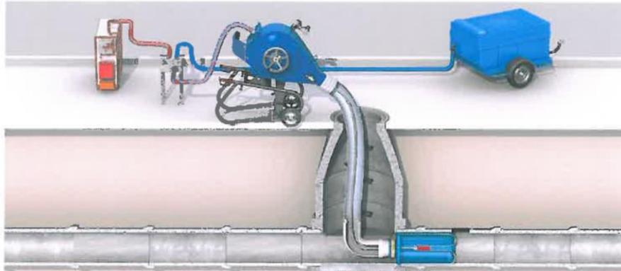
1. Schlauchliner mit eingeklebter LinerEndCap am Startpunkt positionieren.
