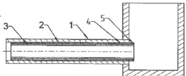
„DrainLiner Verfahren“ mit dem Harzsystem „EPROPOX HC 120 / HC 120+“ zur Sanierung erdverlegter, schadhafter Leitungen von DN 100 bis DN 600
