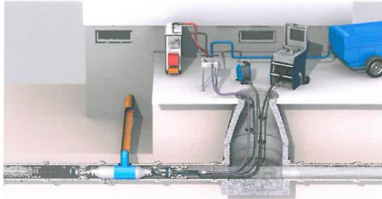
Über den Hebel „Luft/Air“ den Druck soweit steigern, bis die Inversion des Mth-Liners startet. Druck konstant halten (Handbuch und Datenblätter zum DrainMth-Verfahren beachten).
