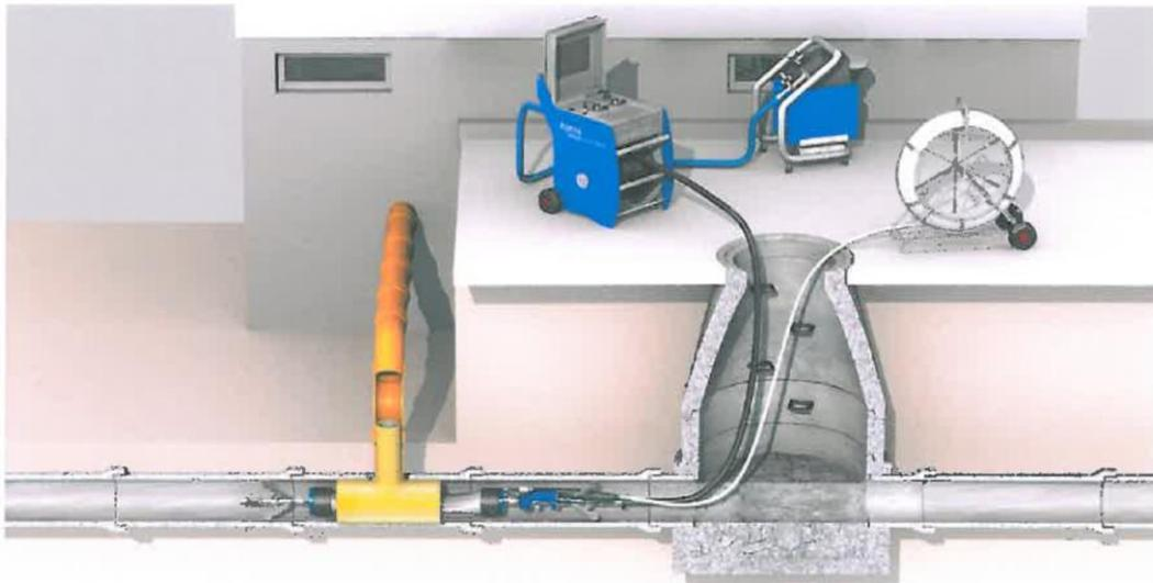
Ist der Aushärtprozess abgeschlossen, wird der Hebel „Pathfinder“ auf die Stellung „down“ gedreht. Den Hebel „Air/Vacuum“ auf „Vacuum“ drehen. Wenn der DrainLCR-S-Packer luftleer ist, kann dieser aus dem Rohr zurückgezogen werden.
