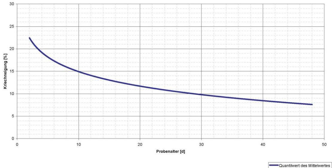
**Diagramm 3:** "Beurteilung der Kriechneigung in Abhängigkeit des Probenalters des Harzsystems "epros®EPROPOX HC120+"
