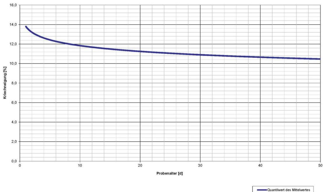
Die in der Prüfung an der auf der Baustelle entnommenen Probe ermittelte Kriechneigung darf in Abhängigkeit des Probenalters den Wert der Kriechneigung aus dem Diagramm 2 und 3 nicht überschreiten.
