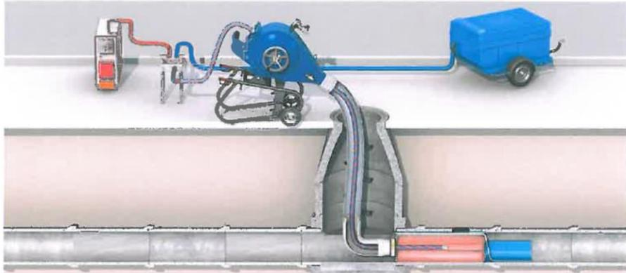
4. Kalibrierschlauch in den Schlauchliner invertieren. Für Zirkulation den Heizschlauch mit invertieren, andernfalls das Dampfauslassventil an den Kalibrierschlauchkopf einbinden.
