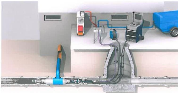
Nach vollständiger Inversion den Druck auf den im Handbuch angegebenen Aushärte-Druck einstellen und konstant halten. Den Hebel „Pathfinder“ an der LCRS/Mth-Steuereinheit auf „down“ drehen. Der DrainMth-Packerkorb senkt sich. Aushärten mit Dampf.
