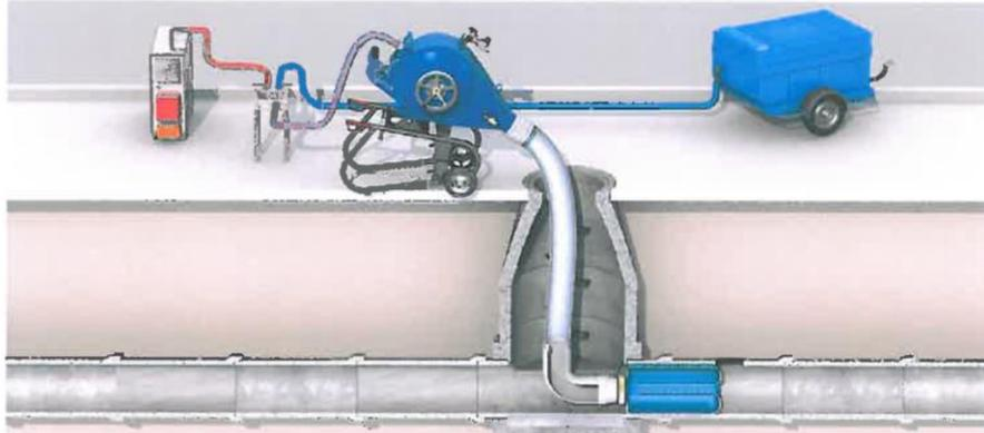
1. Schlauchliner am Startpunkt positionieren.
