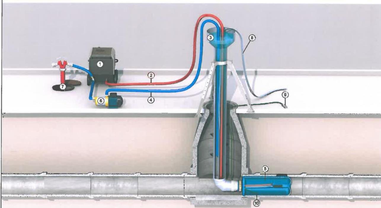
„DrainLiner Verfahren“ mit dem Harzsystem „EPROPOX HC 120 / HC 120+“ zur Sanierung erdverlegter, schadhafter Leitungen von DN 100 bis DN 600
