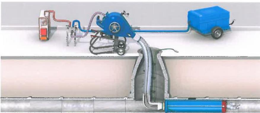
3. Aushärtung mit Kalibrierschlauch, heißes Medium wird zum Schlauchlinerkopf geführt und strömt im Schlauchliner zurück.
