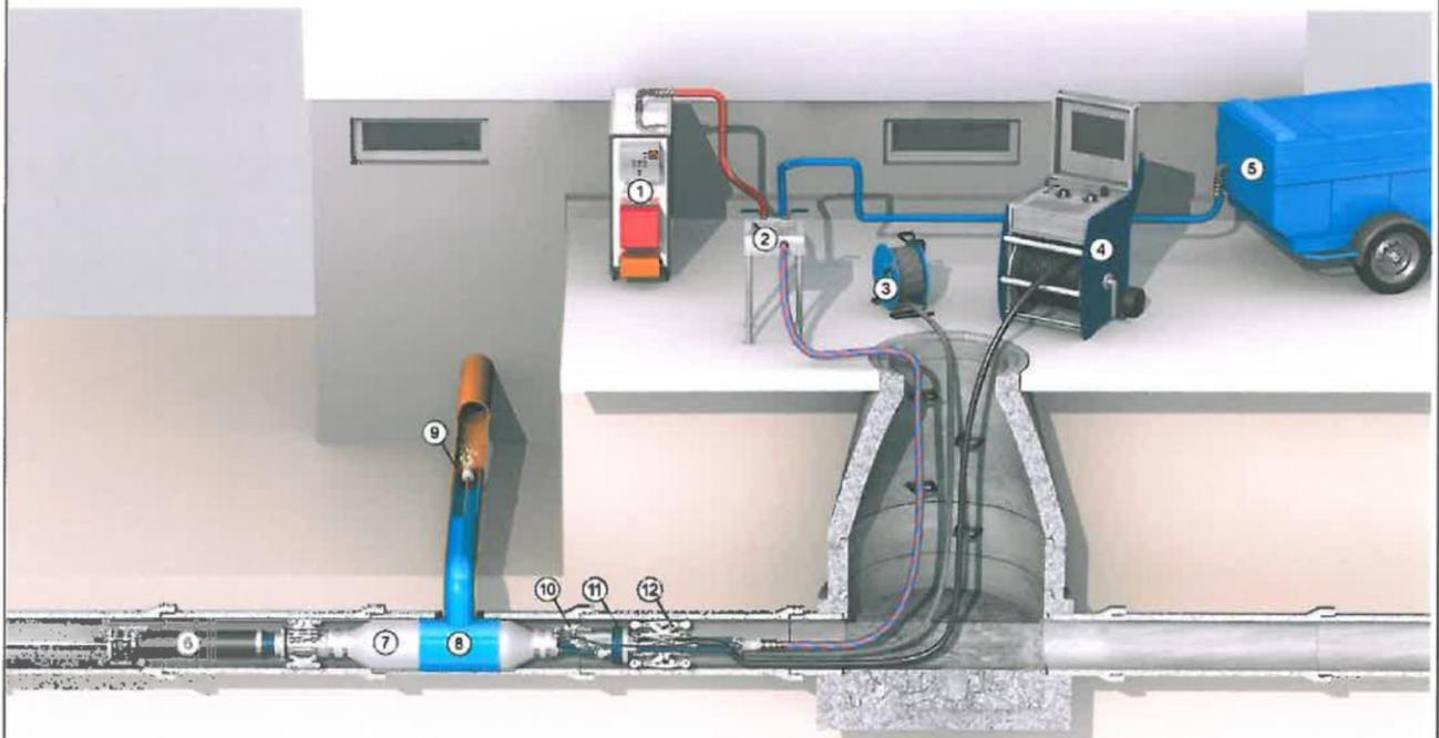
„DrainMth Verfahren“ mit dem Harzsystem „EPROPOX HC 120 / HC 120+“ zur Sanierung erdverlegter, schadhafter Leitungen von DN 100 bis DN 600
