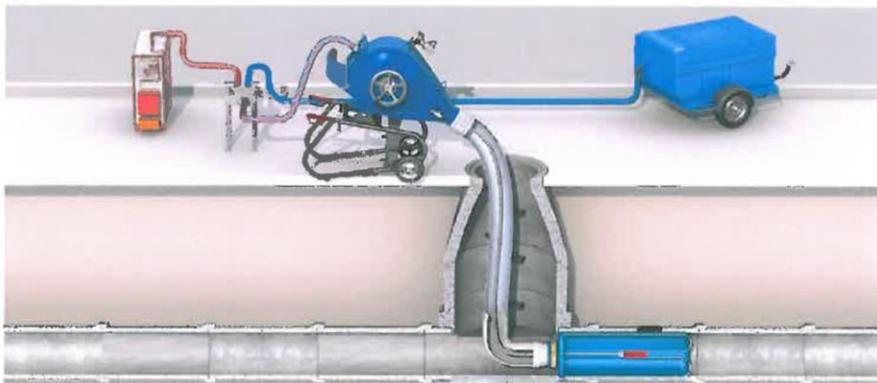
2. Schlauchliner mit LinerEndCap invertieren.
