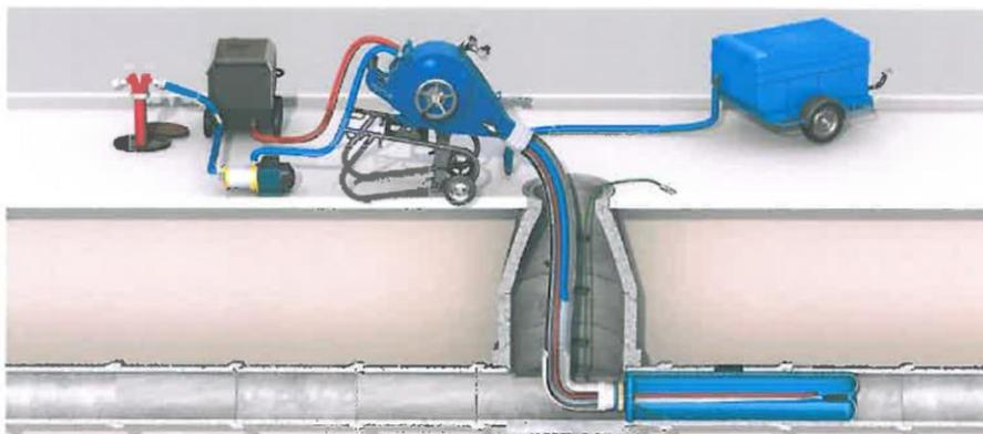
3. Warwasseraushärtung: Medium wird zum Schlauchlinerkopf geführt und strömt im Schlauchliner zurück.
