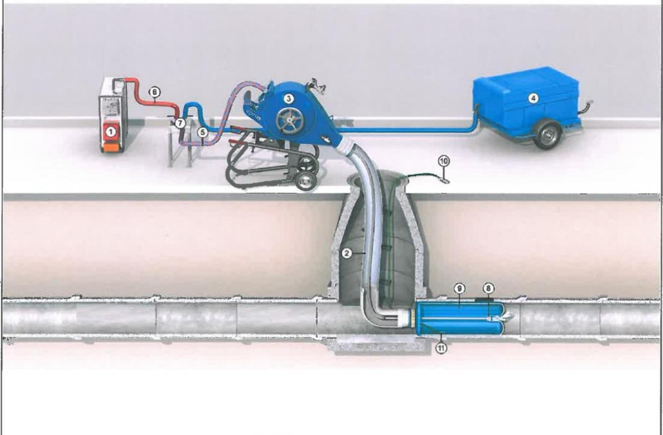
„DrainLiner Verfahren“ mit dem Harzsystem „EPROPOX HC 120 / HC 120+“ zur Sanierung erdverlegter, schadhafter Leitungen von DN 100 bis DN 600
