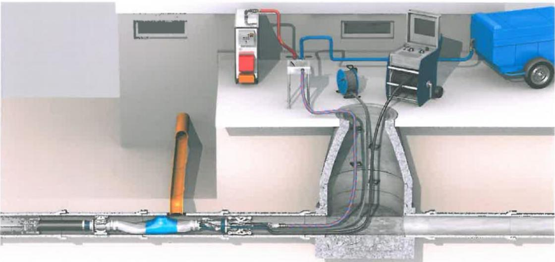
Der DrainMtH-Packerkorb kann angehoben werden. Dazu den Hebel „Pathfinder“ an der LCRS/MtH-Steuereinheit auf „up“ drehen. Der DrainMtH-Packerkorb hebt sich nun gegen die Rohrwandung.
