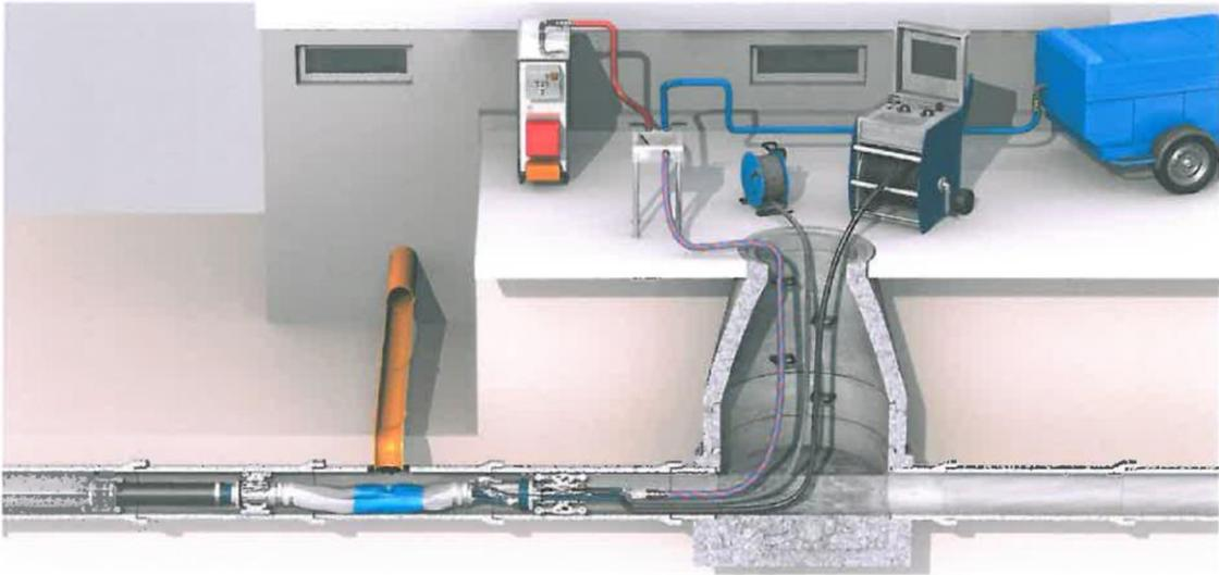
DrainMtH-Packer hinter den Seitenanschluss schieben. Mit Hilfe der Kamera und des Drehantriebes den DrainMtH-Packerkorb in einer Flucht zum sanierenden Seitenanschluss ausrichten.
