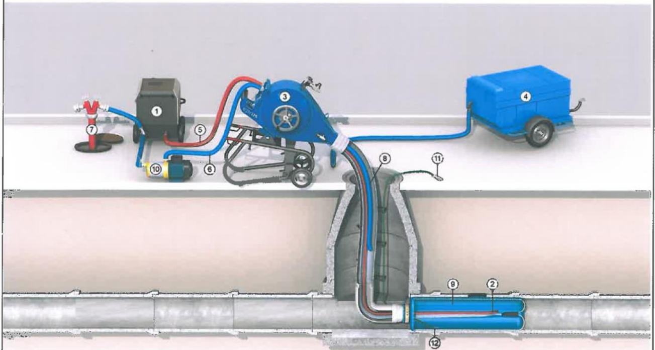
„DrainLiner Verfahren“ mit dem Harzsystem „EPROPOX HC 120 / HC 120+“ zur Sanierung erdverlegter, schadhafter Leitungen von DN 100 bis DN 600
