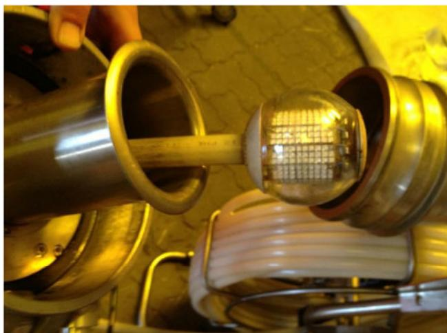
**Abb. 3 kleiner LED Kopf (Kugelkopf)**
