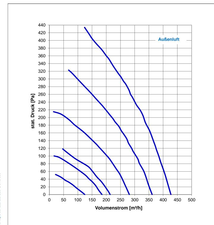
Zentrales Lüftungsgerät mit Wärmerückgewinnung der Baureihe "VALLOX ValloPlus 350"
