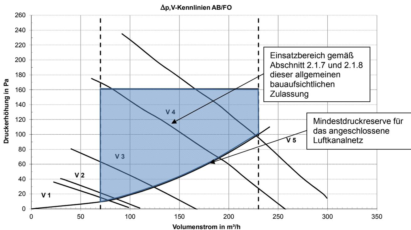
Zentrales Lüftungsgerät mit Wärmerückgewinnung Typ WG 300
