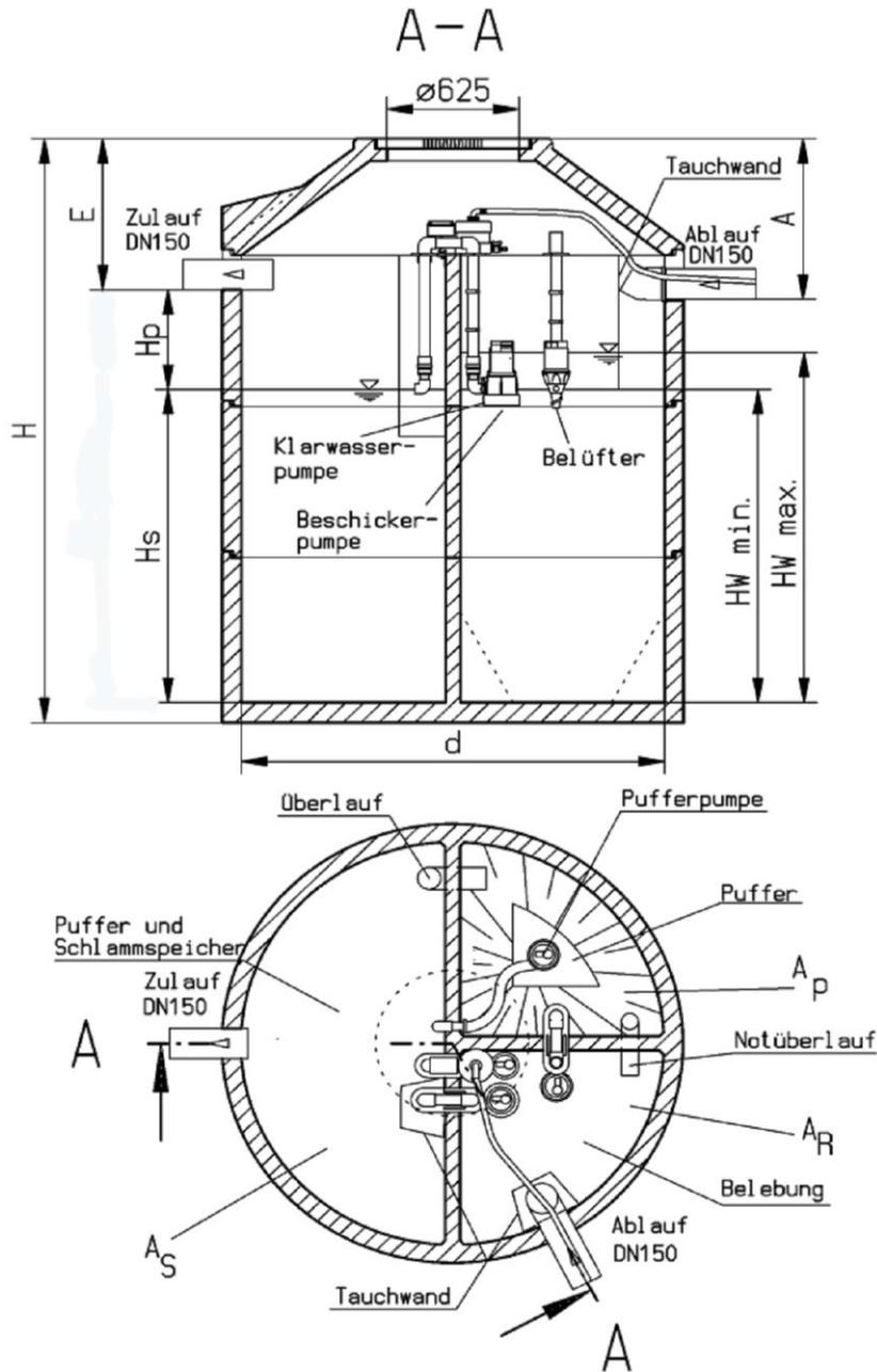
\* Vom jeweiligen Anwendungsfall abhängig, können die Behälterabmessung sowie die damit verbundenen, zusätzlichen Wasserstände des Puffers ( $H_{p,zus}$ ), erheblich variieren. Das erforderliche Puffervolumen ( $V_{p,er}$ ) wird in jedem Fall eingehalten.
