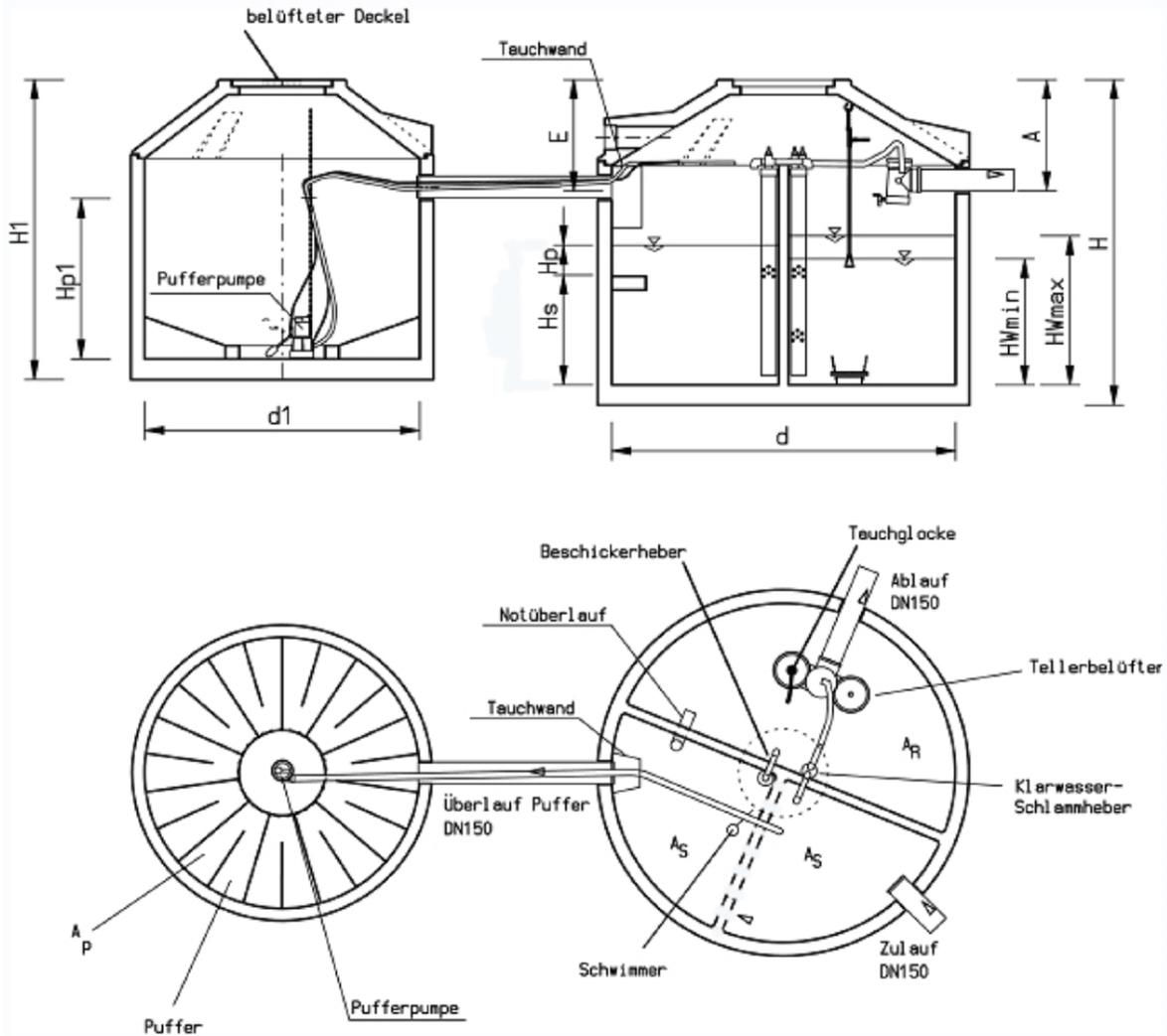
\* Vom jeweiligen Anwendungsfall abhängig, können die Behälterabmessung sowie die damit verbundenen, zusätzlichen Wasserstände des Puffers ( $H_{p,zus}$ ), erheblich variieren. Das erforderliche Puffervolumen ( $V_{p,erf}$ ) wird in jedem Fall eingehalten.
