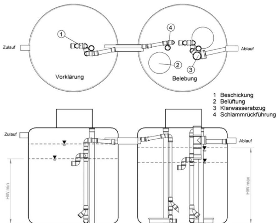
Anwendungsbestimmungen für Kleinkläranlagen nach DIN EN 12566-3 mit CE-Kennzeichnung: SBR-Anlagen Typ Klärmax, Ablaufklasse C
