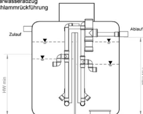
Anwendungsbestimmungen für Kleinkläranlagen nach DIN EN 12566-3 mit CE-Kennzeichnung: SBR-Anlagen Typ Klärmax, Ablaufklasse C
