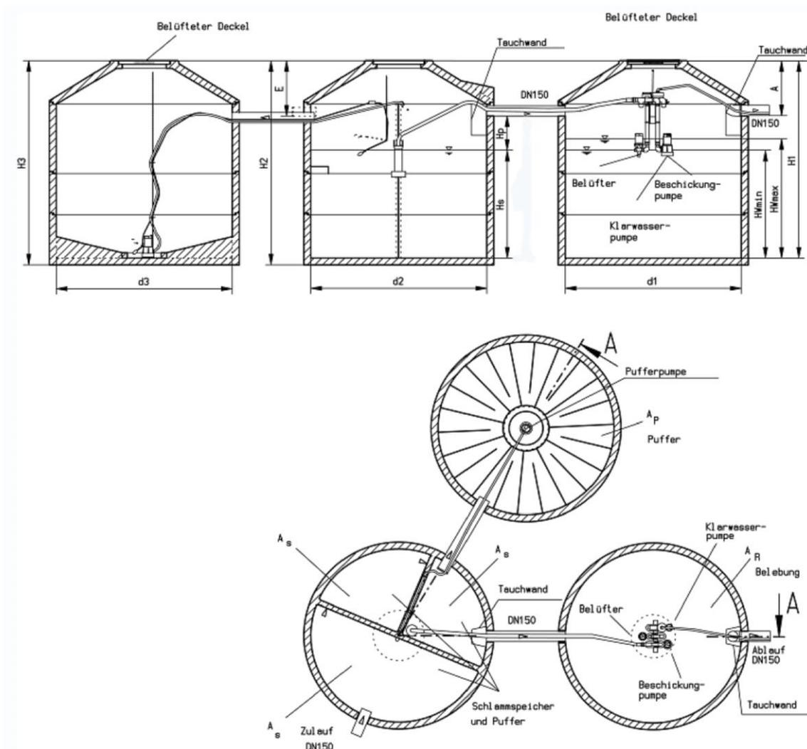
\* Vom jeweiligen Anwendungsfall abhängig, können die Behälterabmessung sowie die damit verbundenen, zusätzlichen Wasserstände des Puffers ( $H_{p,zus}$ ), erheblich variieren. Das erforderliche Puffervolumen ( $V_{p,erf}$ ) wird in jedem Fall eingehalten.
