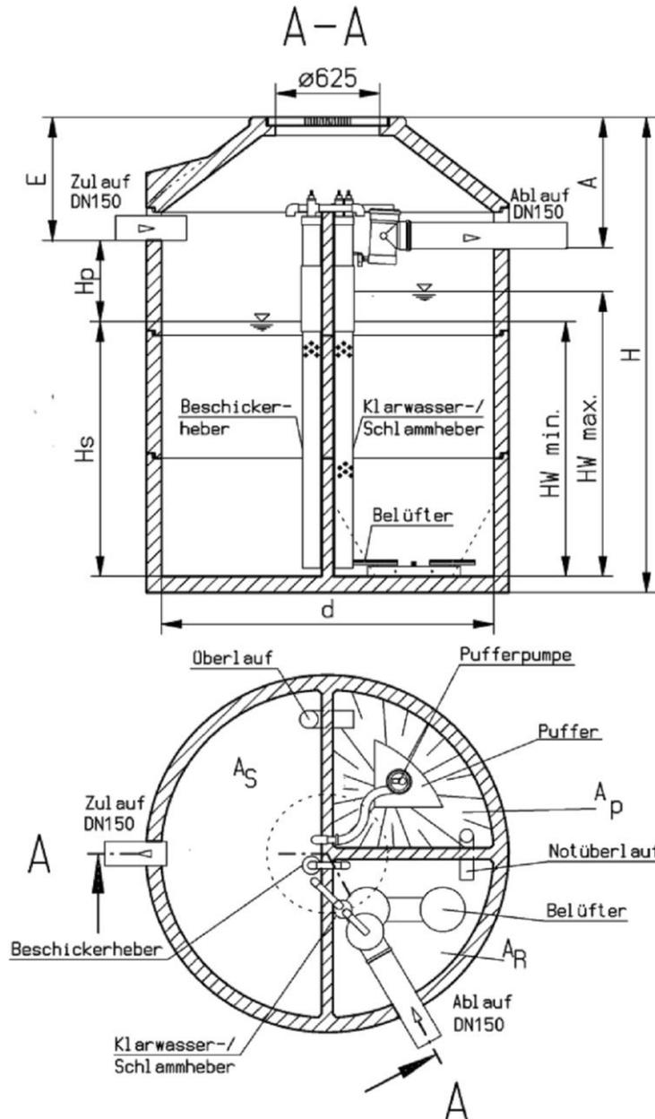
\* Vom jeweiligen Anwendungsfall abhängig, können die Behälterabmessung sowie die damit verbundenen, zusätzlichen Wasserstände des Puffers ( $H_{p,zus}$ ), erheblich variieren. Das erforderliche Puffervolumen ( $V_{p,erf}$ ) wird in jedem Fall eingehalten.
