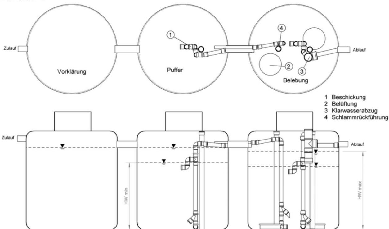
Anwendungsbestimmungen für Kleinkläranlagen nach DIN EN 12566-3 mit CE-Kennzeichnung: SBR-Anlagen Typ Klärmax, Ablaufklasse C
