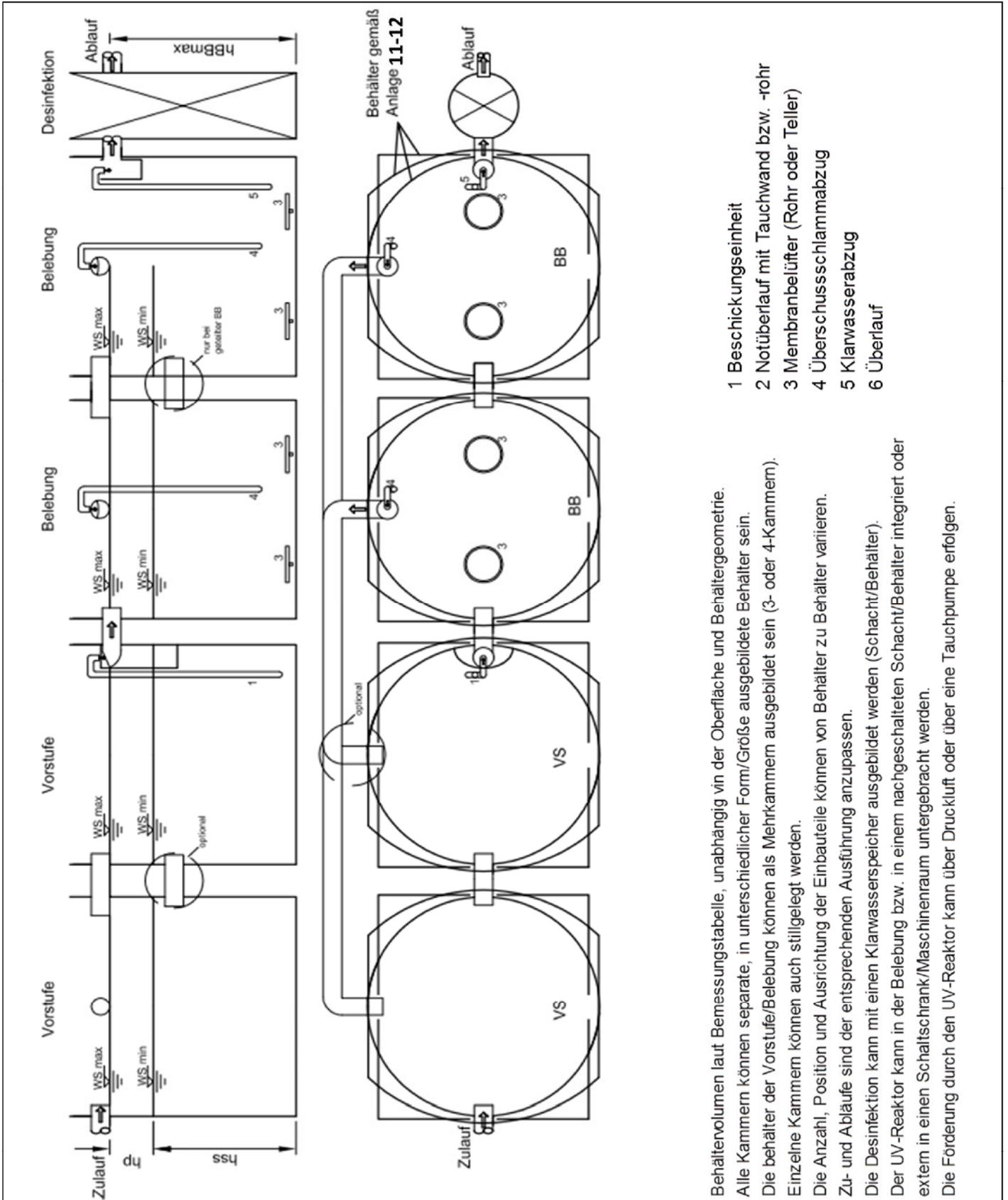
Anwendungsbestimmungen für Kleinkläranlagen nach DIN EN 12566-3 mit CE-Kennzeichnung: SBR-Anlagen Typ Klaro / Klaro Easy aus Beton, PE oder PP, Ablaufklasse D+H
